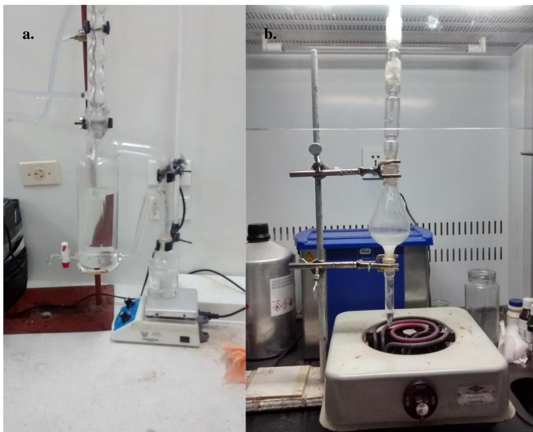
**Figura 8. a.** Proceso de extracción líquido - líquido. **b.** Proceso de concentración con el Kuderna - Danish.
