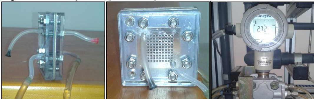
Figura B2. Montaje de la prueba de presión hidrostática.
