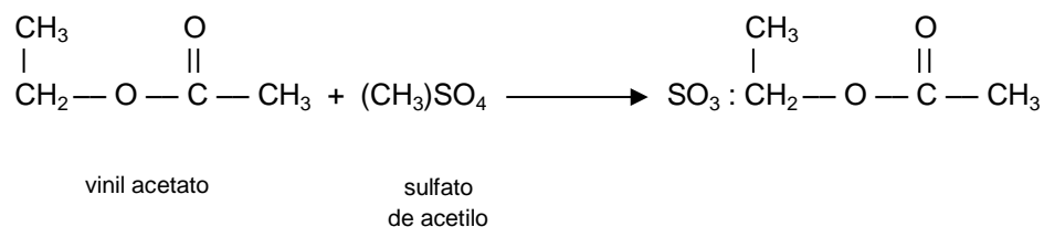
Figura C1. Mecanismo de sulfonación del vinil acetato.
