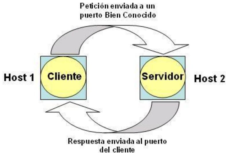
**Figura 4. Funcionamiento Cliente-Servidor**
