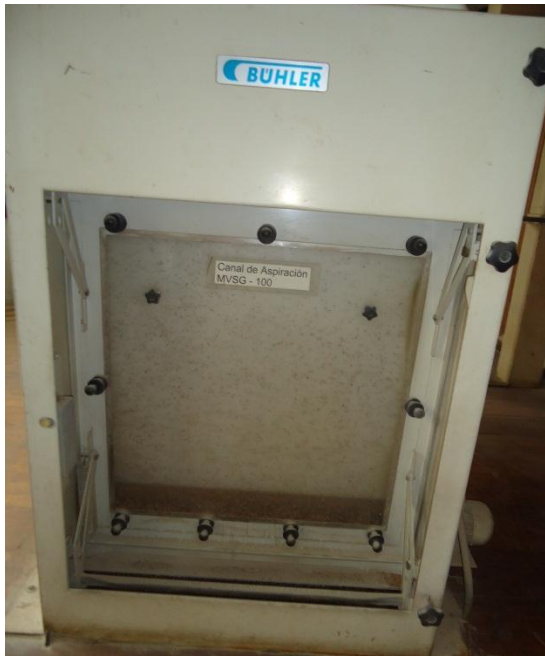
Figura 17. Canal de Aspiración MVSG – 100
