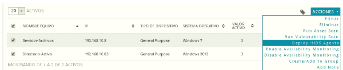
Figura 22. Configuración del agente HIDS en el Servidor de Archivos y en el Directorio Activo.
