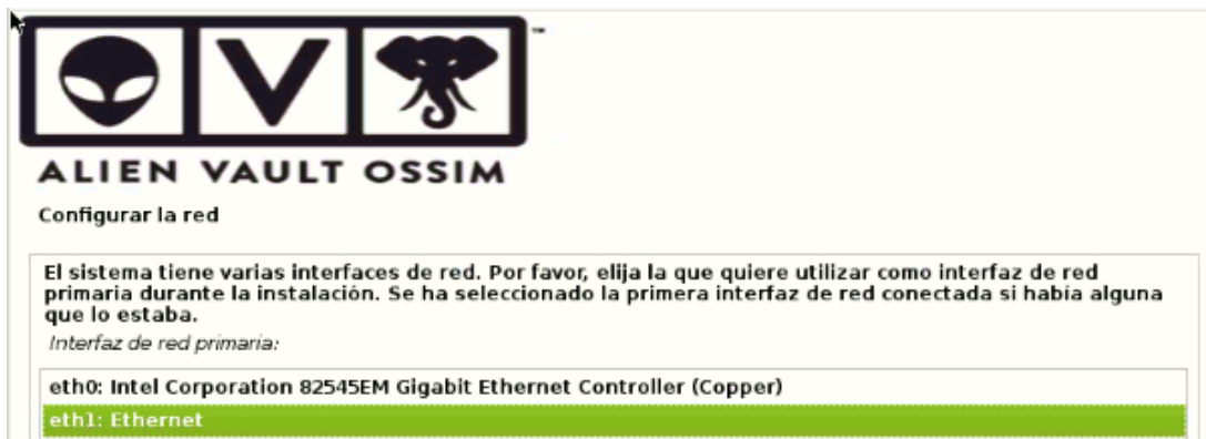
Figura 8. Selección de la tarjeta de red principal.
