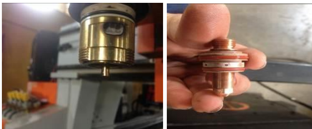
Figuras 14 y 15 Inspección de sistema de antorcha, verificación de tuberías de gases, tubo de refrigeración y estado de consumibles Fuente: Base de datos rep COTECMAR
