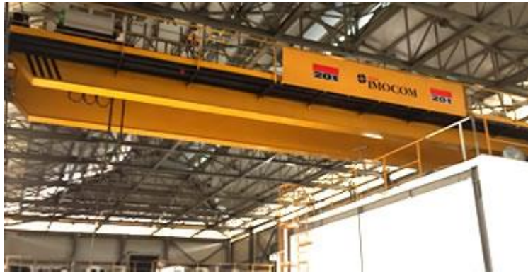
Figura 7 Puente grúa de 5t gecon 201 Imocom Fuente: productos y servicios IMOCOM
