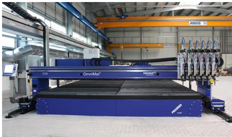
Figura 8 Mesa de corte CNC para corte de lámina CNC OmniMat I 6000 Fuente: Productos OmniMat
