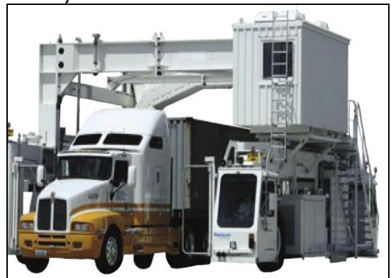
Figura 32: Equipo de inspección no intrusiva Semi-fijo
