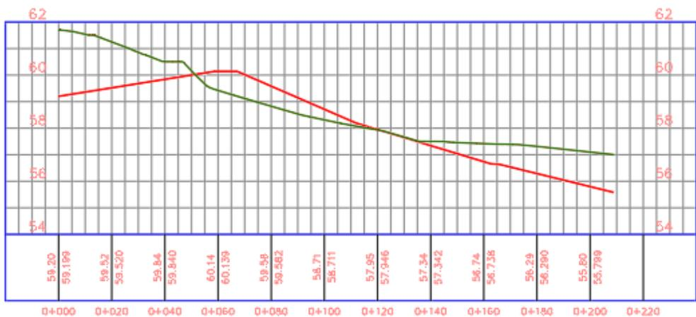
**Ilustración 60** Superposición de perfil longitudinal zona 1 año 2018 identificado con color Verde y año 2005 identificado con color rojo, sector del cono volcánico principal de El Rodeo.
