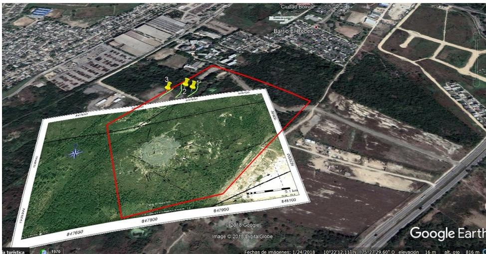
**Ilustración 41.** Direccionamiento de fallas y ramas desprendidas de la falla principal (Falla Mamonal), los puntos indicados indican la ubicación de surcos y cárcavas con el direccionamiento paralelo a la falla principal y que se extienden en toda la longitud de la urbanización.
