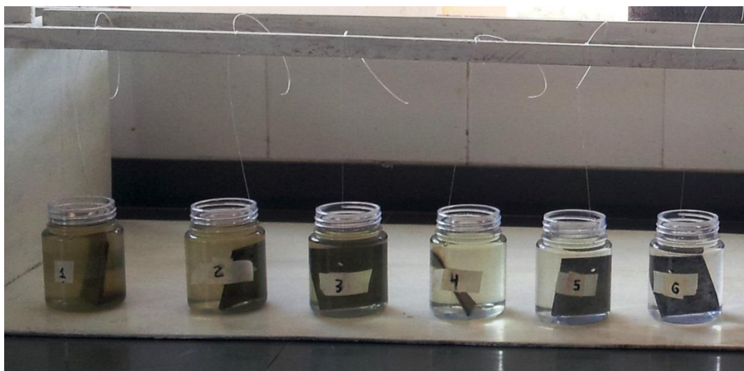
Figura 5: Montaje prueba isotermas de adsorción.
