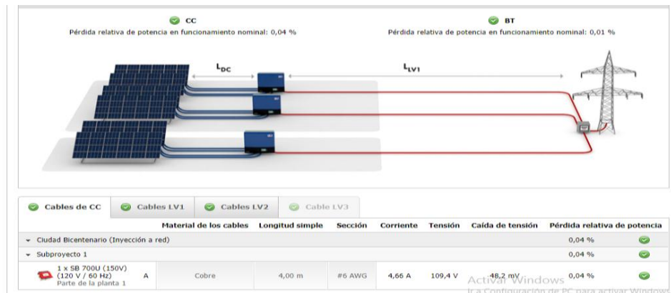
Figura 18. Dimensionamiento del cableado.
