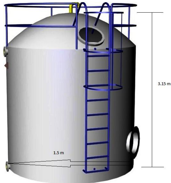
Figura 15. Representación del tanque de almacenamiento de aceite
