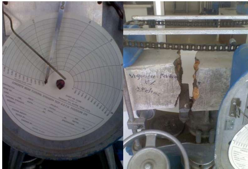
Figura A 16.a. Toma de muestra de ensayo de Flexión; b. Ruptura de la vigueta.
