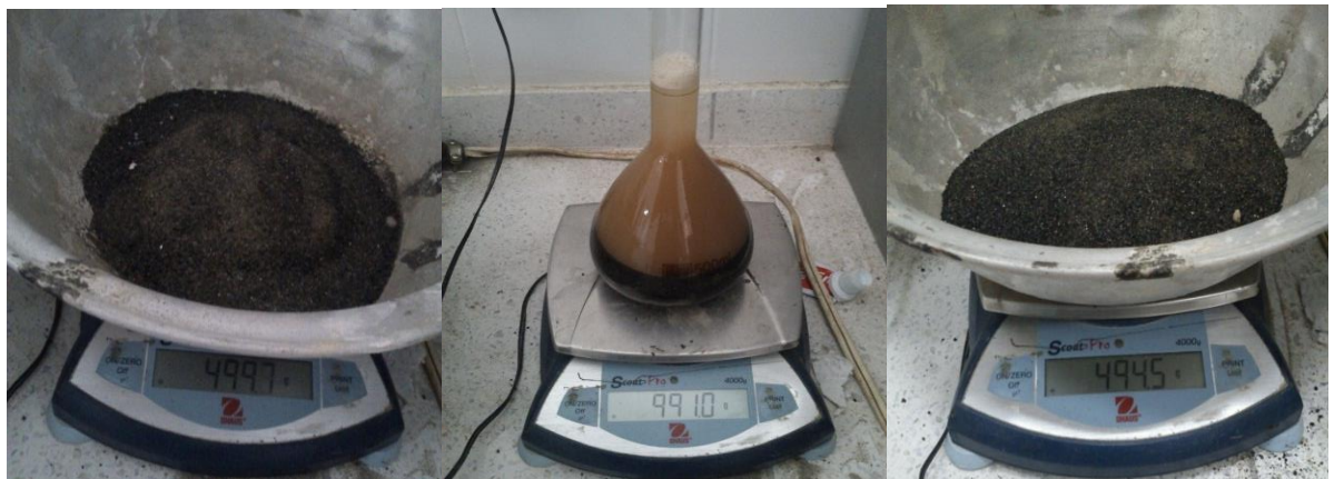
Figura A 6. a. Peso de la muestra de residuo saturada superficialmente seca; b. Peso del Picnómetro más el agua adicionada y la muestra saturada superficialmente seca; c. Peso de la muestra seca.
