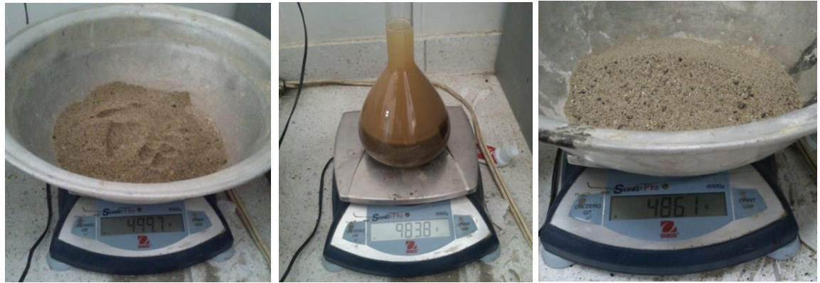
Figura A 5. a. Peso de la muestra saturada superficialmente seca; b. Peso del Picnómetro más el agua adicionada y la muestra saturada superficialmente seca; c. Peso de la muestra seca.
