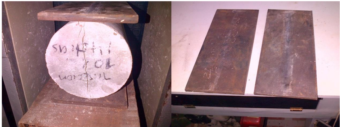
Figura A 14.a. Ruptura del cilindro; b. platinas de hierro.
