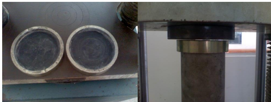
Figura A 12. Bandas de neopreno y haz de luz entre la máquina y las bandas con la muestra.
