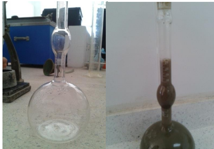
Figura A 2. a. Frasco de Le Chatelier; b. Frasco con la solución de kerosene más 64g de cemento
