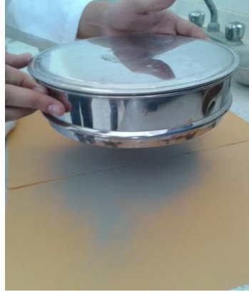
Figura A 1. Finura del cemento (Proceso de tamizado del cemento)
