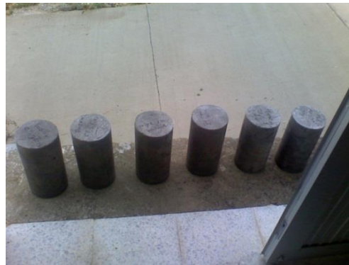
Figura A 11. Muestras cilíndricas de la piscina y secadas superficialmente.
