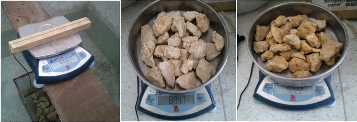
Figura A 3. Peso del agregado grueso saturado sumergido en agua; b. Peso del agregado grueso saturado superficialmente seco; c. Peso del agregado grueso seco en el aire.
