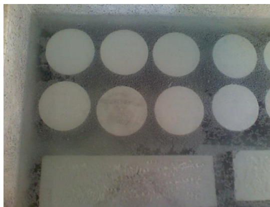
Figura A 9. Piscina de curado de cilindros y viguetas.
