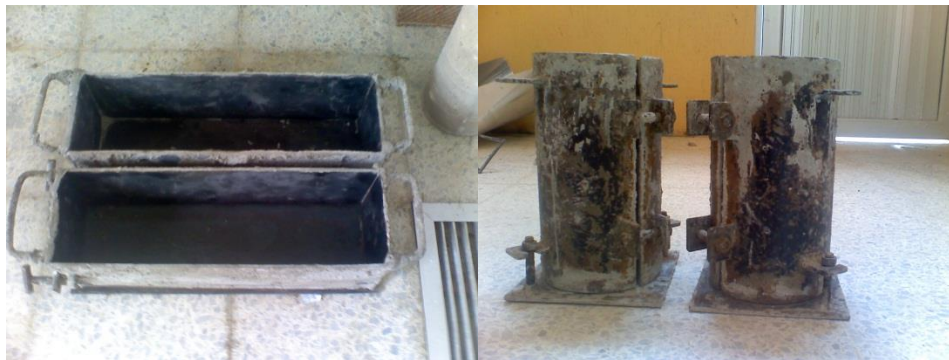
Figura A 8. Moldes para cilindros y viguetas.
