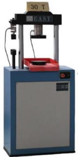
*Figura 2. Máquina de ensayo a compresión*
