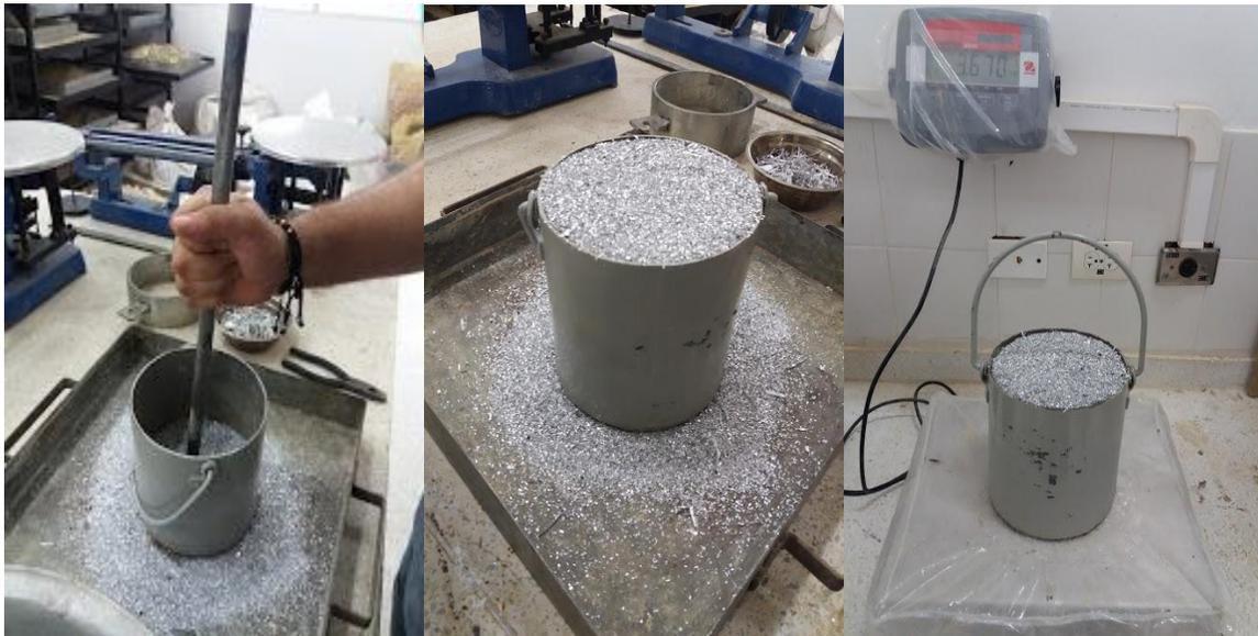
*Figura 8. Proceso de medición del peso unitario viruta de aluminio en el laboratorio.*
