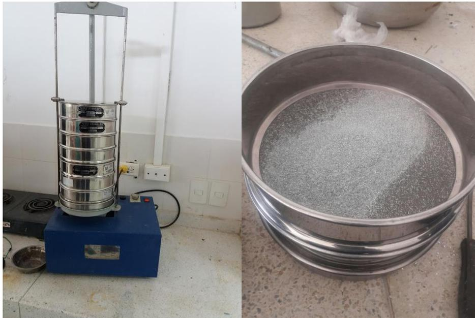
*Figura 6. Tamizado de la viruta de aluminio.*
