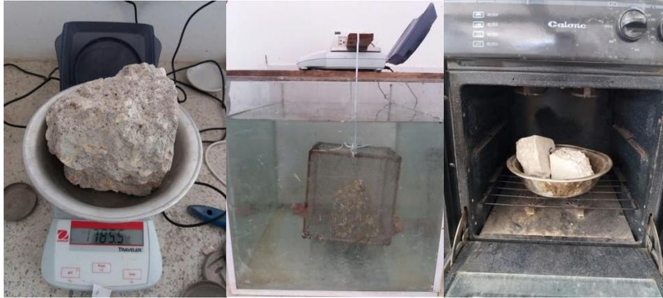
**Figura 9.** Mediciones para determinar la densidad y la absorción.
