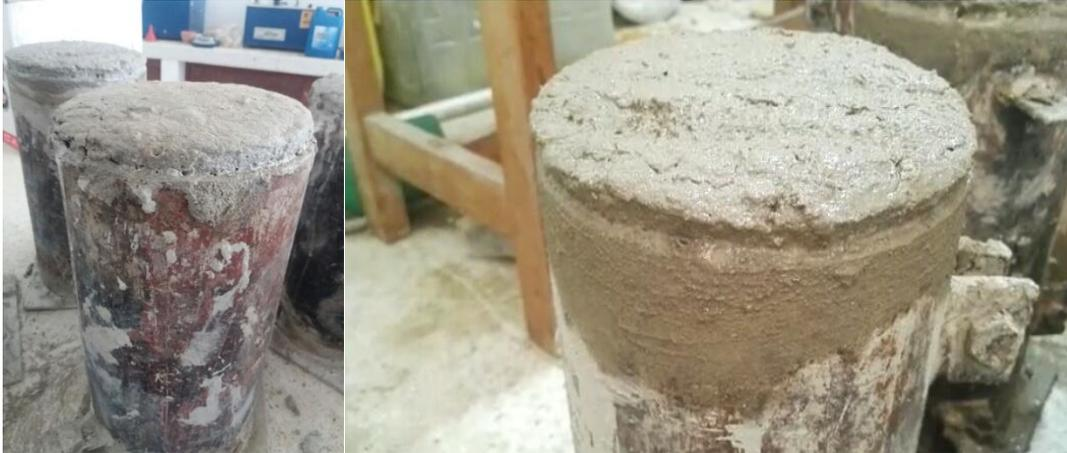
*Figura 11. Concreto expandido en estado fraguado y en momentos posteriores al vaciado en estado plástico.*
