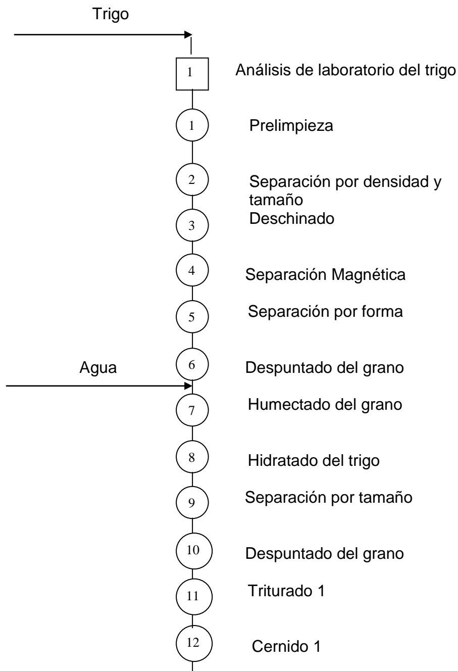
Figura 9. Diagrama de operaciones de la producción de harina de trigo de primera (congelados, panificación, industrial, pastelera y punto rojo) en la presentación de 50 kg
