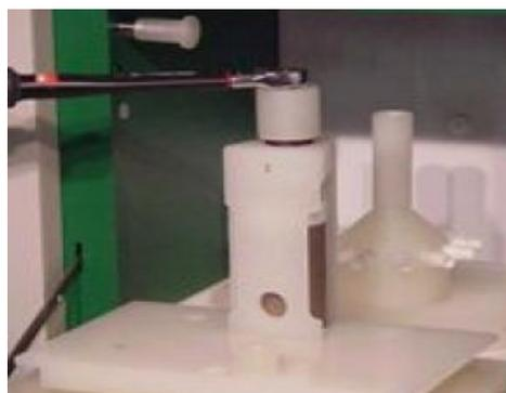
9. Una vez sellado se procede a colocar los vasos simétricamente en el plato de rotor de el microondas milestone; teniendo en cuenta la inserción de la termocupla en el vaso de referencia y luego se le coloca la tapa de seguridad superior.
