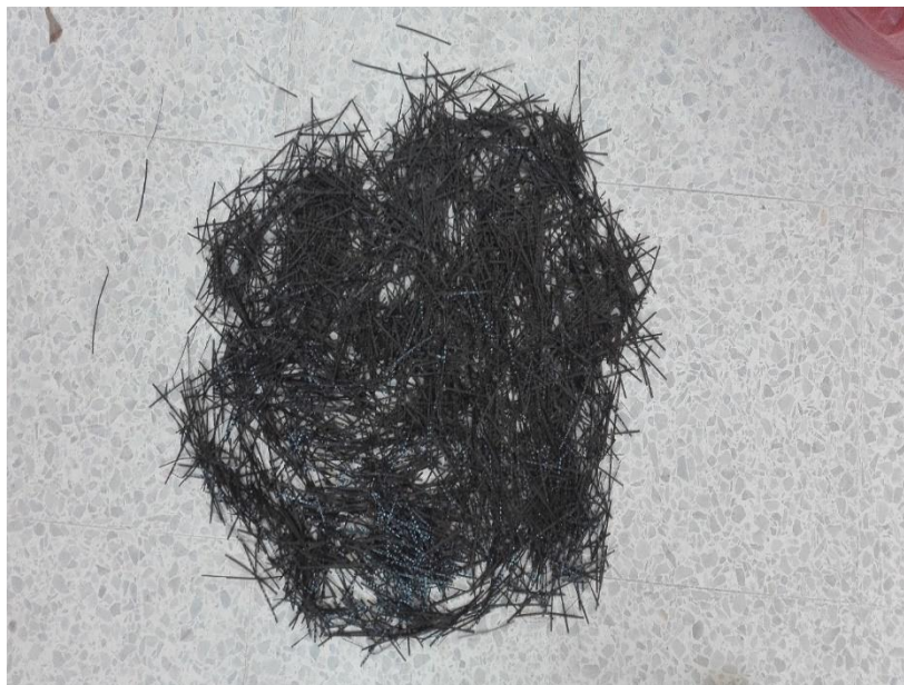
Ilustración 3 Cortes realizados al geotextil tejido T2400
