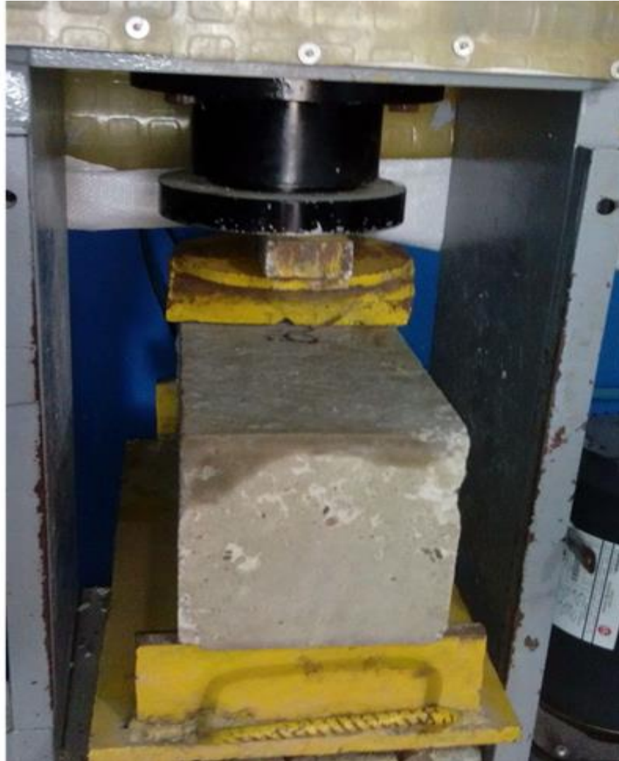
Ilustración 9 Ensayo a flexión a una vigueta de estudio.
