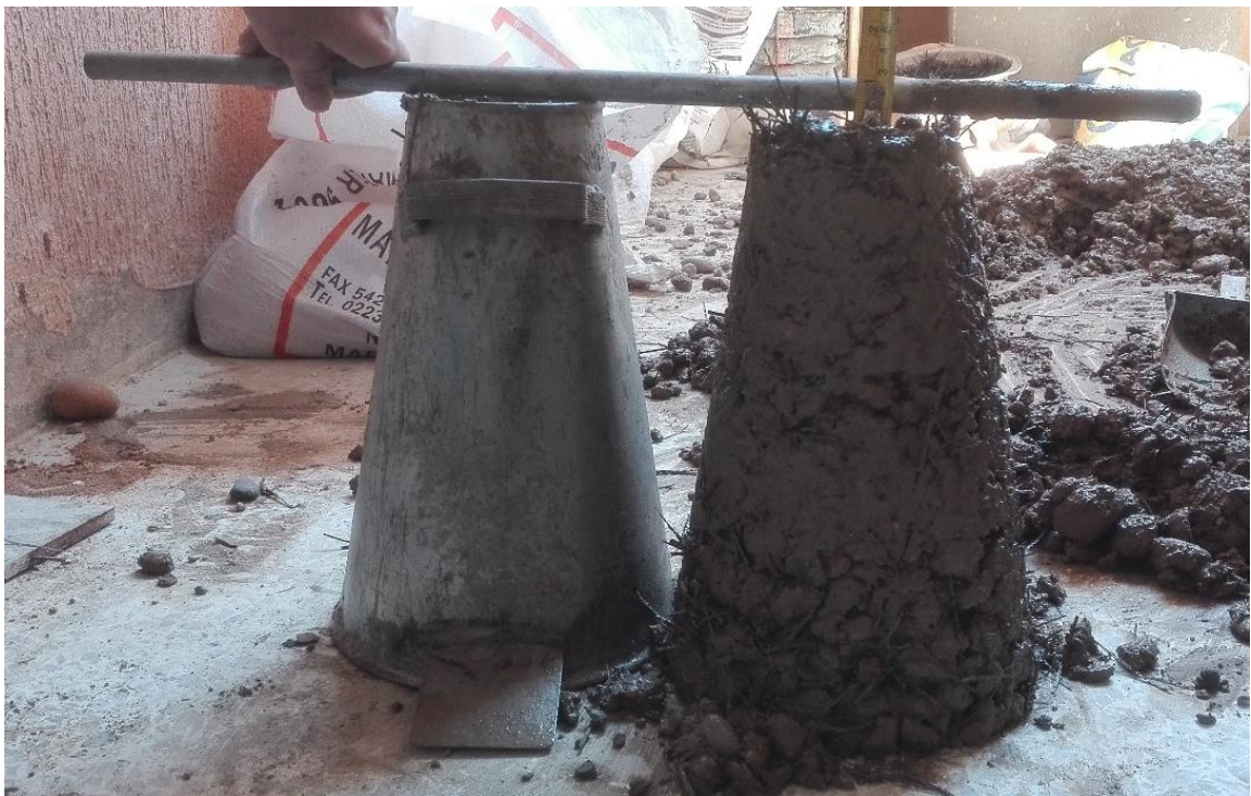
Ilustración 10 Ensayo del cono de Abrams para un porcentaje de geotextil del 30% en su versión tejida
