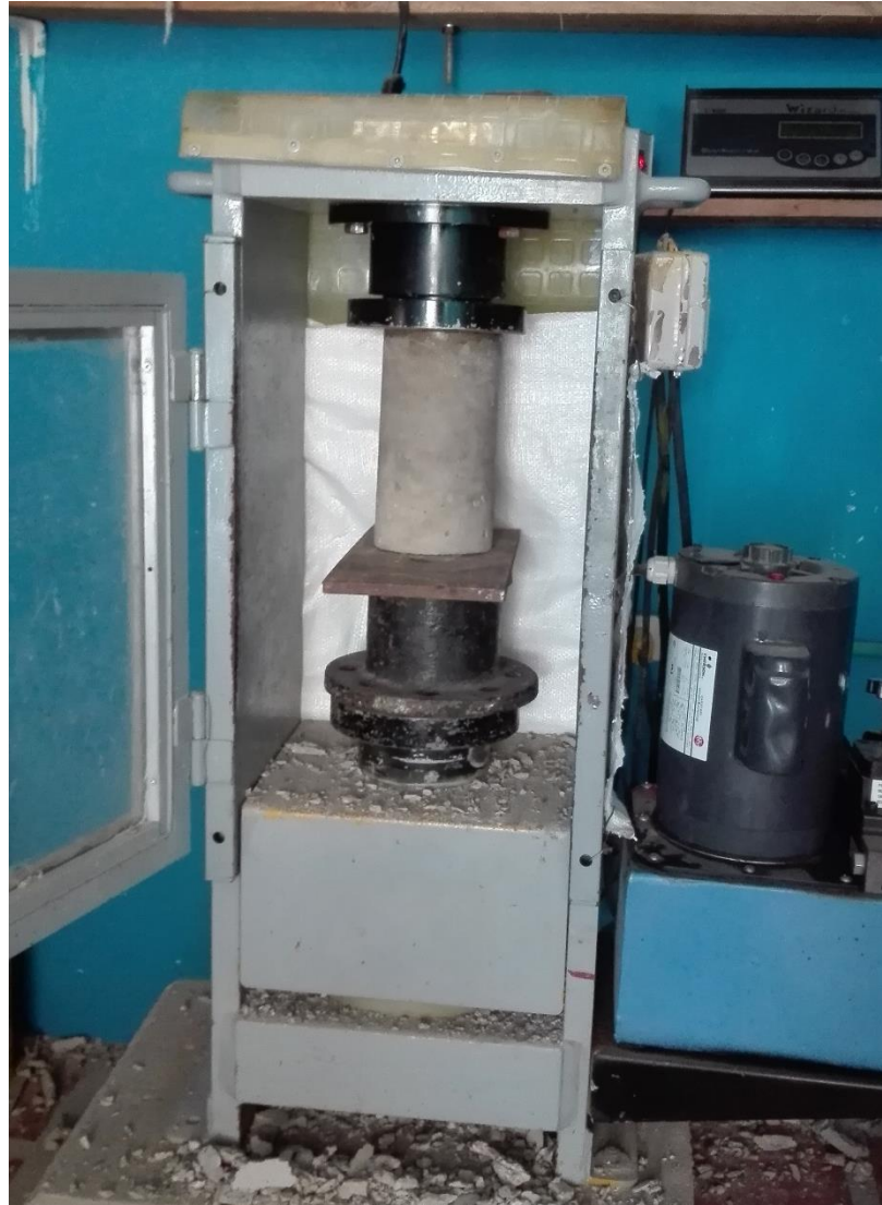
Ilustración 8 Ensayo a compresión para un cilindro de estudio.
