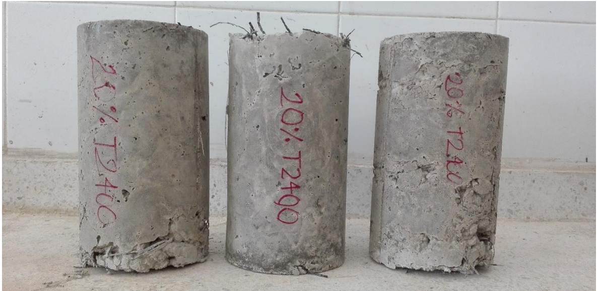
Ilustración 14 Aspecto físico de muestras de concreto para ensayos a compresión con una dosificación del 30% de geotextil T2400
