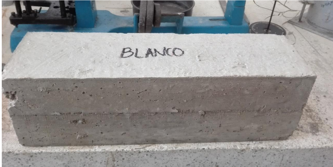
Ilustración 12 Aspecto físico de muestras de concreto para ensayos a flexión sin adición de fibras de geotextil.
