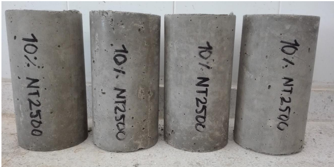
Ilustración 11 Aspecto físico de muestras de concreto para ensayos a compresión con una dosificación del 10% de geotextil NT2500
