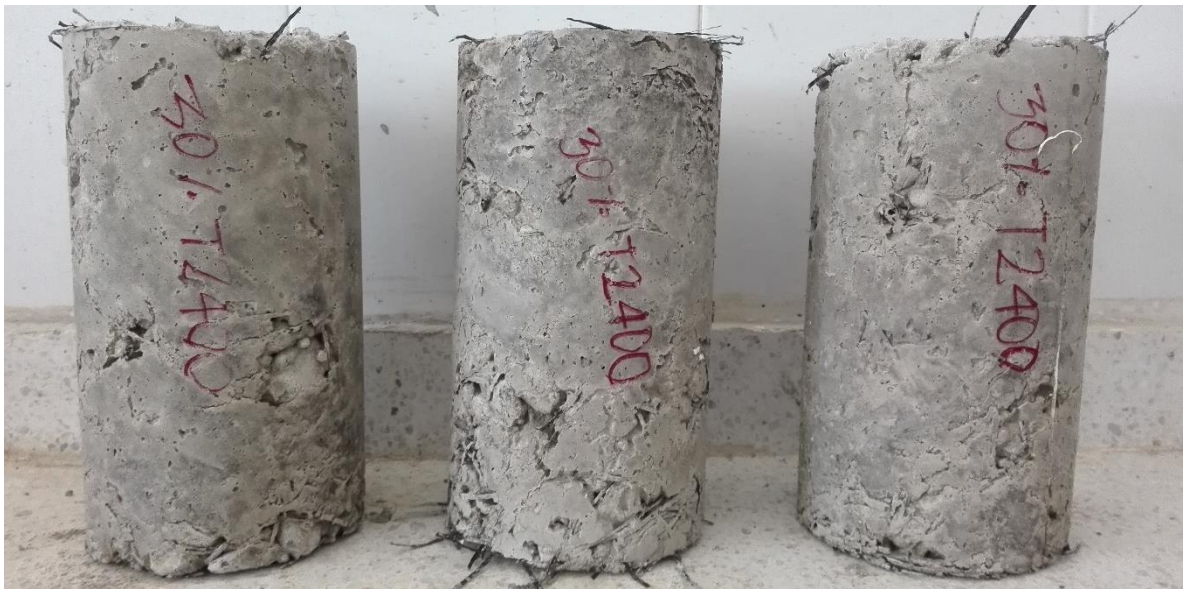
Ilustración 14 Aspecto físico de muestras de concreto para ensayos a compresión con una dosificación del 30% de geotextil T2400
