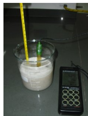
Ajuste de pH con pH-meter HANNA HI 9216
