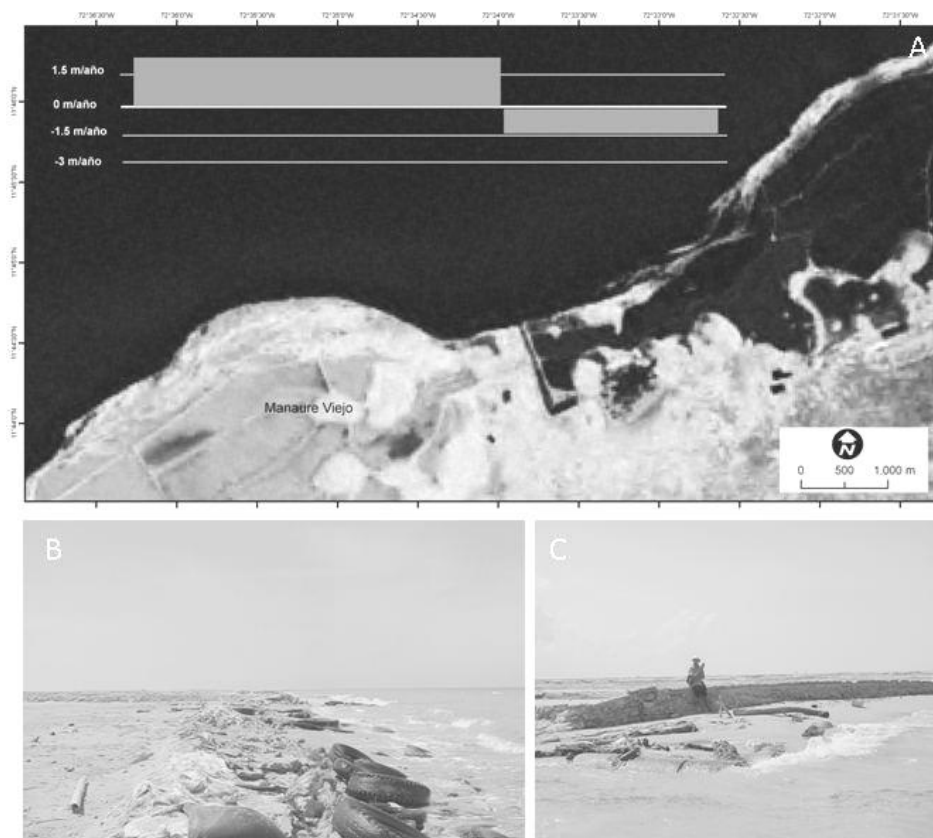
Figura 6. Evolución litoral en Manaure. A. Tasas de erosiones calculadas para Manaure entre 1971-2003. B y C. Destrucción de salinas a causa de la erosión. Se observan algunas llantas de camiones utilizadas como medida de protección.
