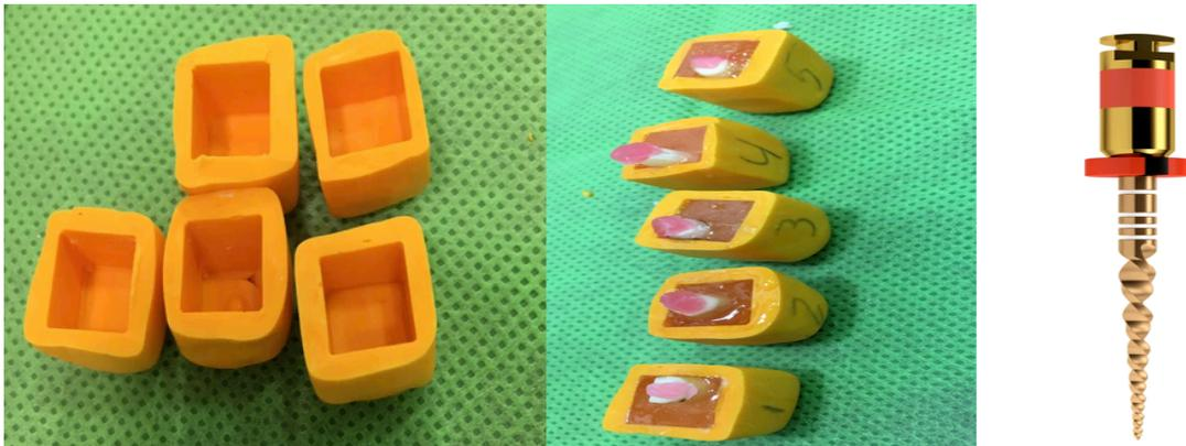
Figura 3. Colocación de muestras en resina epóxica.
