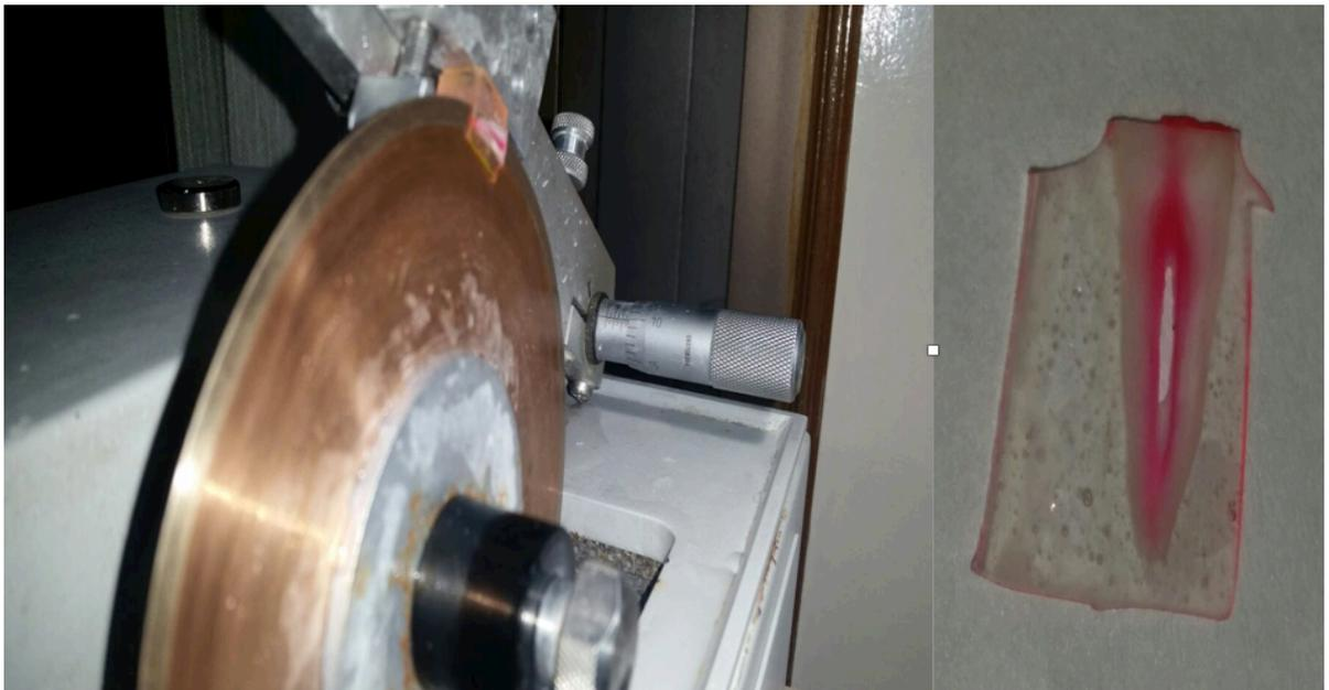
Figura 4. Fotografía Micro-cortadora Isomet BUEHLER, corte longitudinal de muestra 500  $\mu\text{m}$ .
