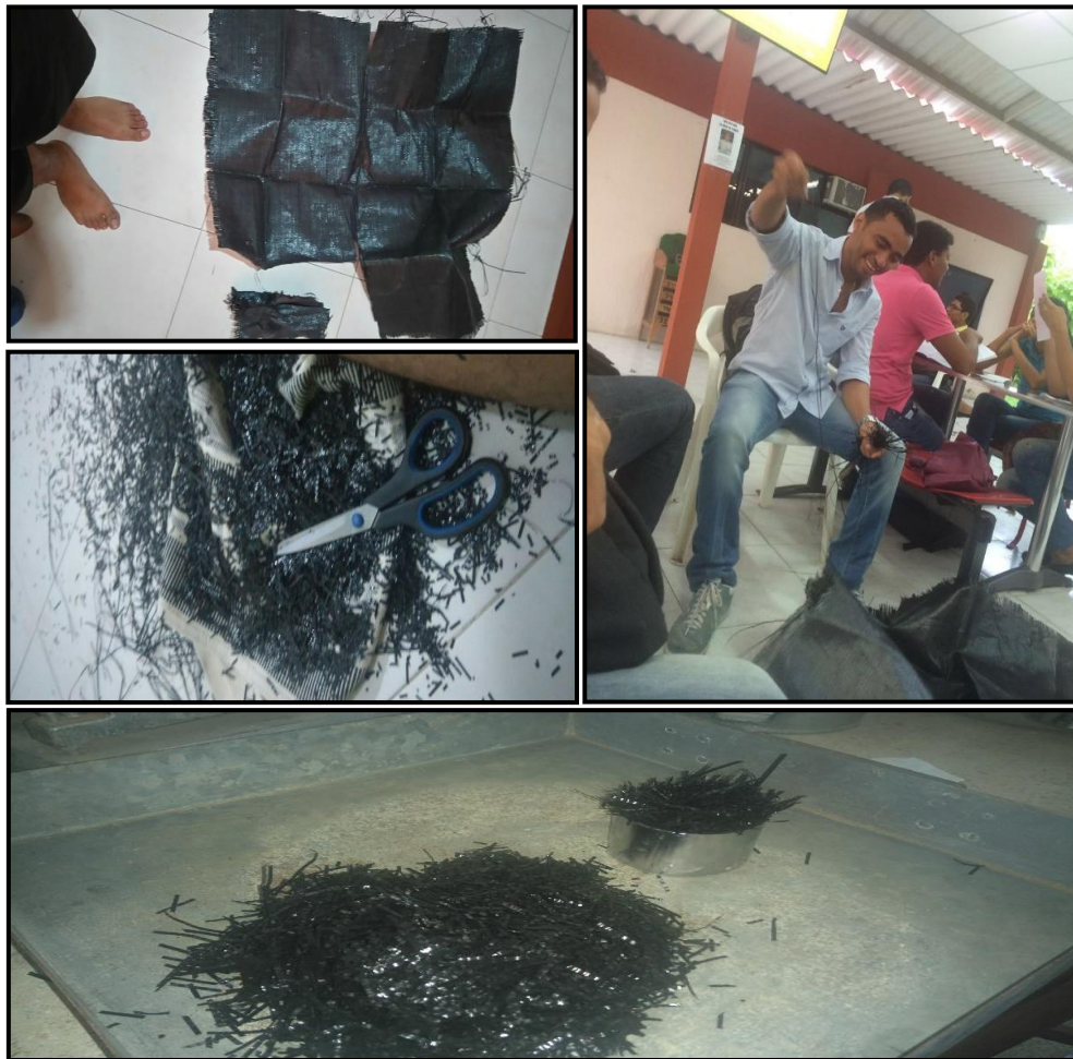
Imagen 1 Proceso de preparación de la fibra de geotextil T2400
