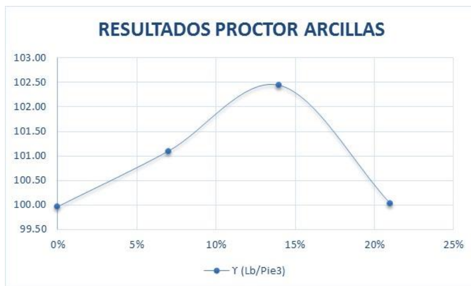
Grafica 1 Variación de la densidad máxima seca en material tipo Arcilla
