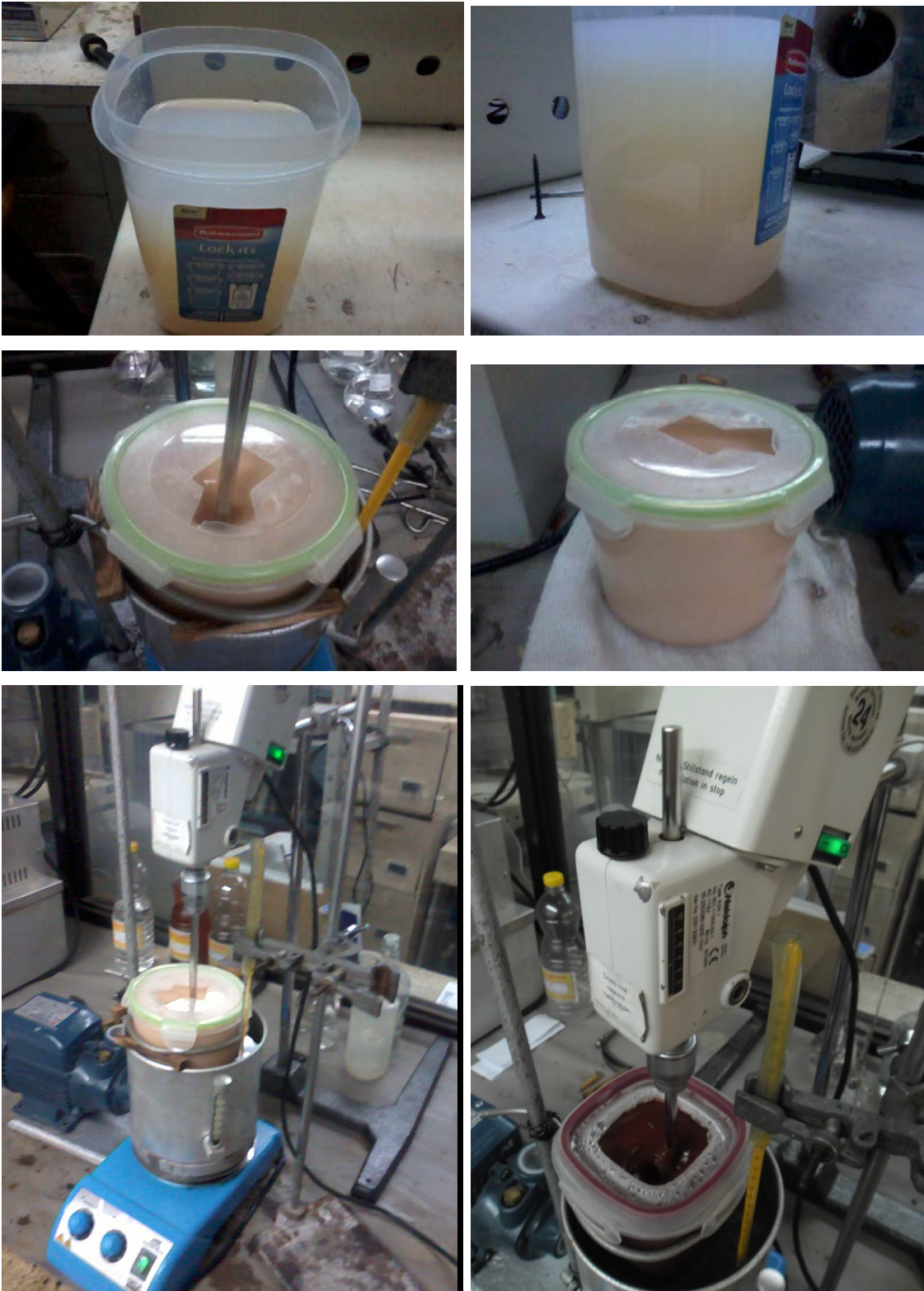
Figura 15. Superior: Mezcla inicial de reactivos. Central: Mezcla día 2. Inferior Izquierda: Mezcla día 2 con agitación-calentamiento. Inferior Derecha: Día 3.
