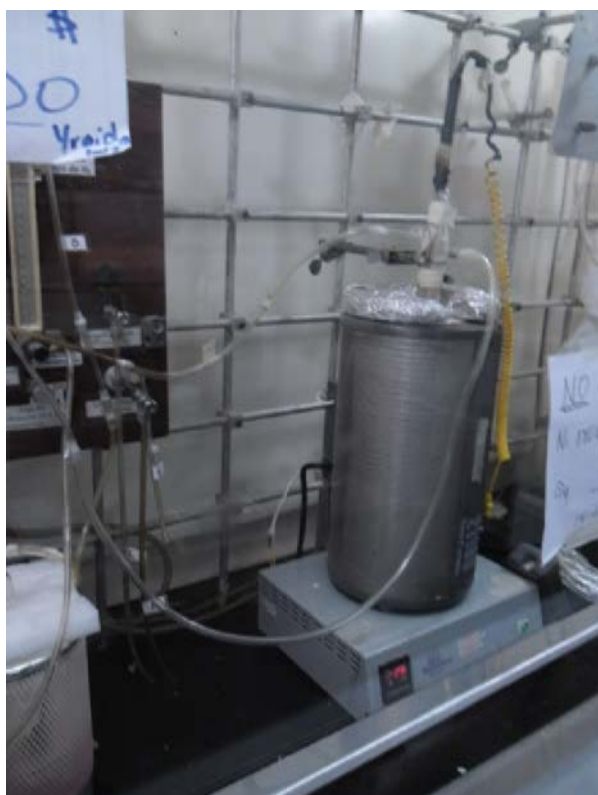
Figura 20. Superior: Cromatógrafo para monitoreo de especies durante ensayos catalíticos. Inferior: Reactor para ensayos catalíticos. (IVIC-Caracas)
