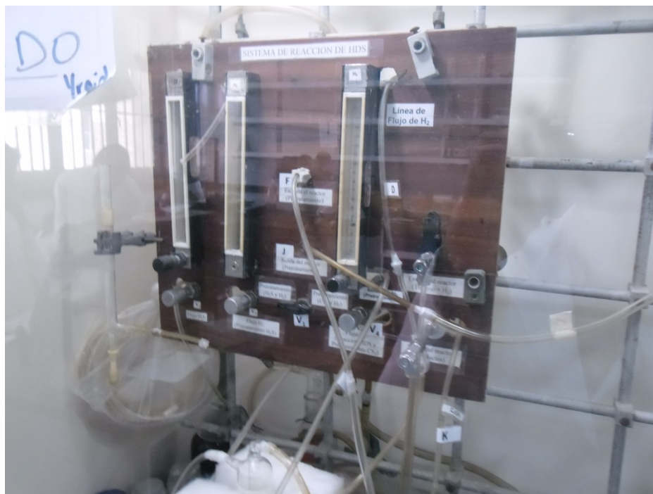
Figura 21. Superior: Burbujeador de mezcla gaseosa Hidrógeno-Tiofeno, Hidrógeno-Agente Sulfurante. Inferior: Panel con juego de válvulas y tuberías de alimentación-salidas conectadas al reactor de ensayos catalíticos. (IVIC-Caracas)
