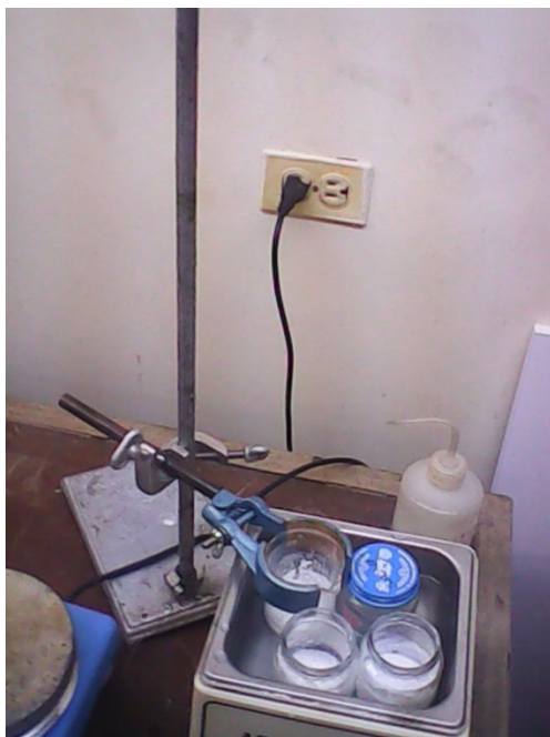
Figura 18. Superior: Síntesis de Molibdato Ferroso. Inferior Izquierda: Impregnación sobre Titania. Inferior Derecha: Síntesis de Molibdato Férrico. Laboratorio de Investigaciones en Catálisis y nuevos materiales LICATUC- Unicartagena.
