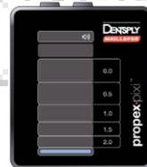
Nota: Una barra que parpadea indica una conexión fallida. Si ocurriera, comprobar las conexiones de los cables, limpiar el gancho de conexión y el clip de labio, humedecer el conducto si fuera necesario y empezar de nuevo.
