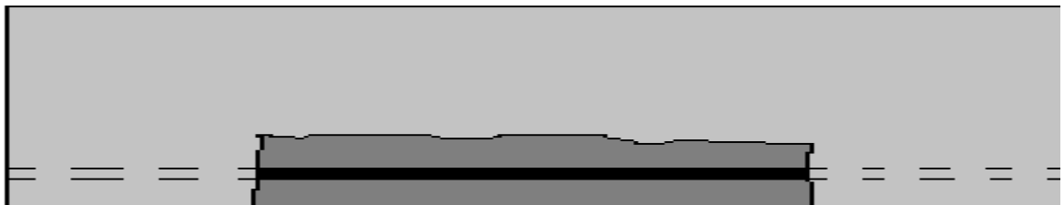
Figura 41. Remoción de masa de concreto dañada
