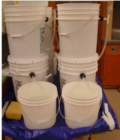
Figura 3. Filtros lentos de arena diseñados por estudiantes de la Universidad de Purdue.
