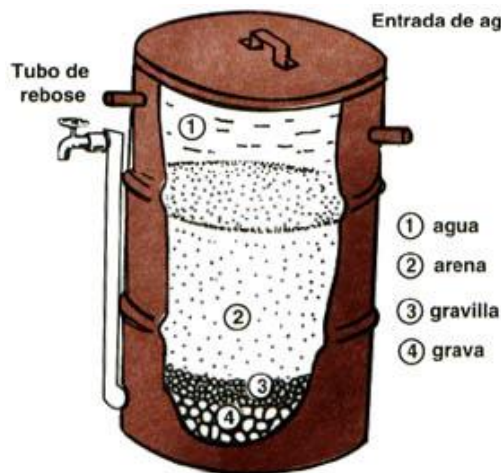
Figura 5. Componentes básicos de un filtro lento de arena.
