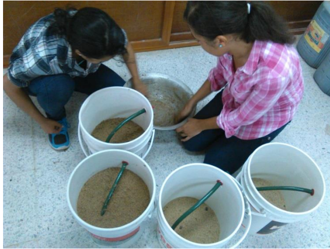
Figura 16. Colocación de la capa de arena en los filtros a escala de laboratorio.
