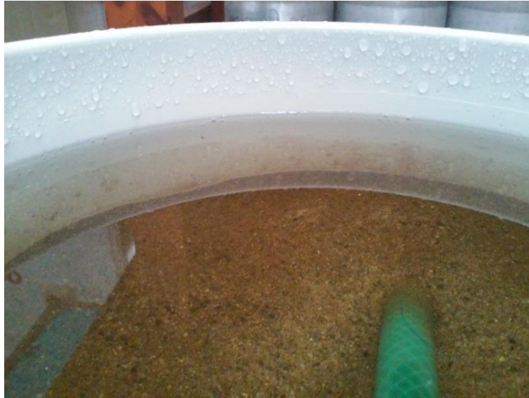
Figura 31. Etapa inicial de la capa biológica en los filtros lentos de arena a escala de laboratorio.
