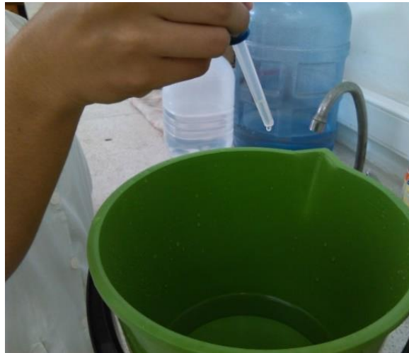
Figura 19. Cloración del agua filtrada
