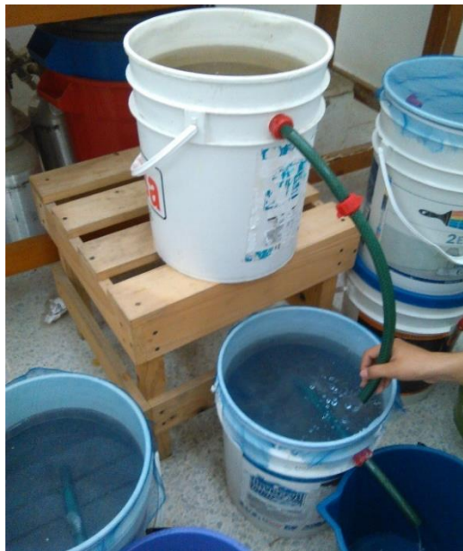
Figura 17. Unidad de filtro lento de arena
