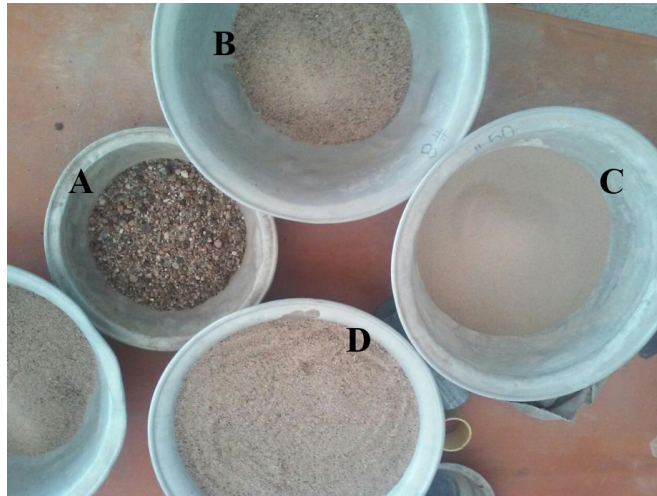
Figura 13. Materiales obtenidos con el tamizado de la arena
