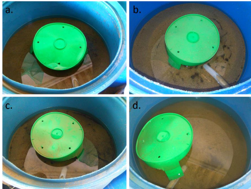
Figura 40. Evolución de la capa biológica de uno de los filtros. a. 12 de agosto. b. 19 de agosto. c. 9 de septiembre. d. 16 de septiembre.
