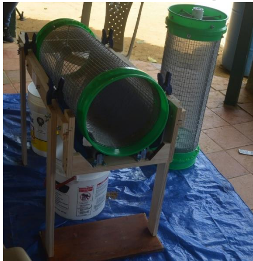
Figura 24. Tamiz rotatorio de tambor diseñado por GEP usado en Playón
