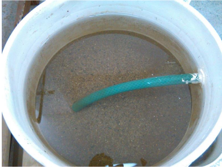
Figura 32. Capa superficial de los filtros durante su operación.
