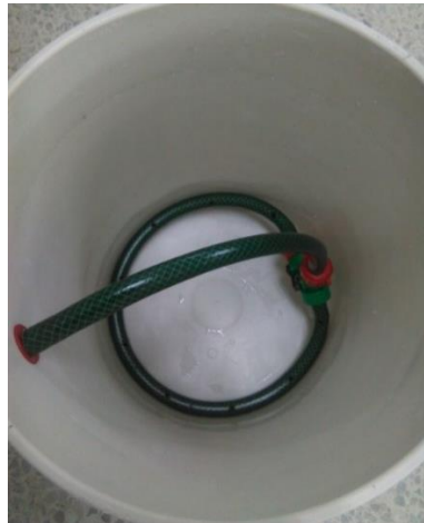
Figura 14. Balde, mangueras y accesorios usados en la construcción de los filtros a escala de laboratorio.
