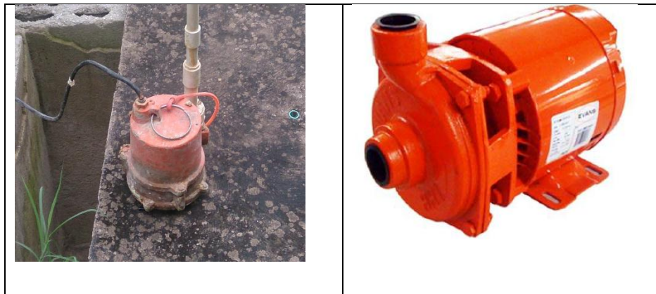
Figura 19. Bomba sumergible y motobomba centrifuga.Fuente: elaboración propia
