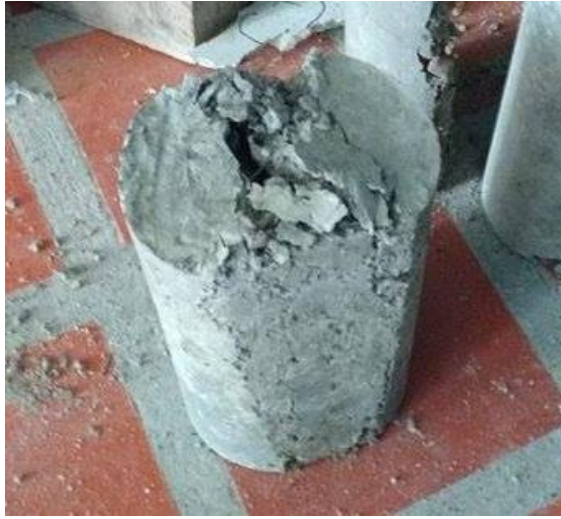
Figura 18. Espécimen con 100% de cuesco ensayado a tracción indirecta
