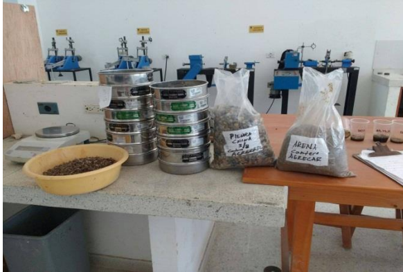
Figura 6. Materiales y equipos utilizados en la granulometría
