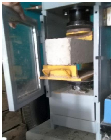
Figura 10. Ensayo de resistencia a Flexión
