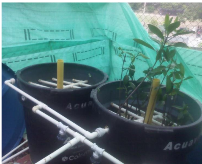
Fotografía 1: filtro biológico y reactor #1
