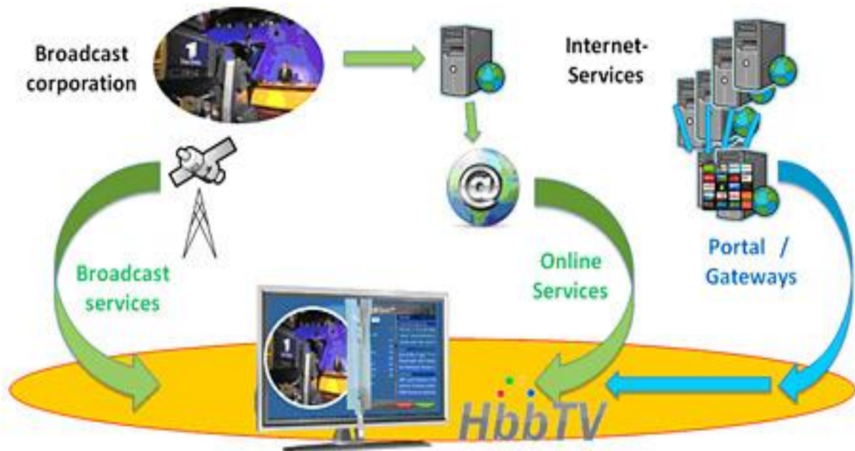
Figura 8. Modelo de comunicación HBBTV(hbbtv)
