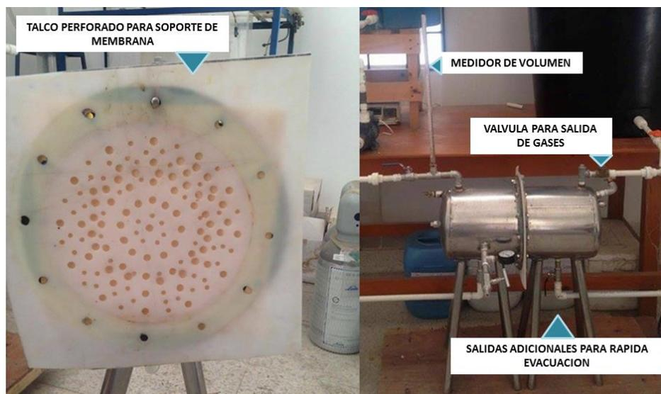
FIGURA 23 COMPONENTES ADICIONALES DEL REACTOR
