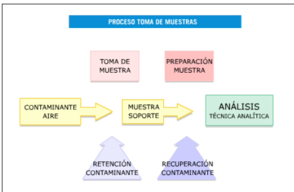
Ilustración 1. Proceso toma de muestras de contaminantes químicos.
