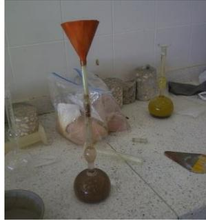
**Ilustración 22** Consistencia Normal.
