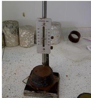
**Ilustración 26** Preparación Para Tiempo de Fraguado.
