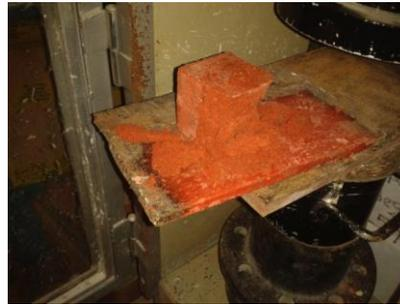
**Ilustración 3** Consistencia Normal Aparato de Vicat
