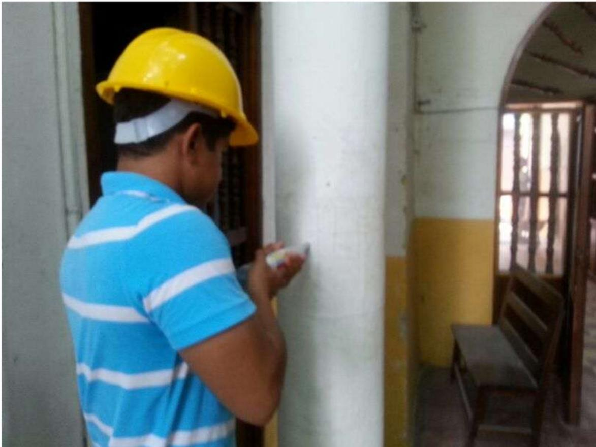
Ilustración 3 Prueba de Esclerómetro Casa Cural de Iglesia de Santo Toribio Columna C-1 Fuente: El autor
