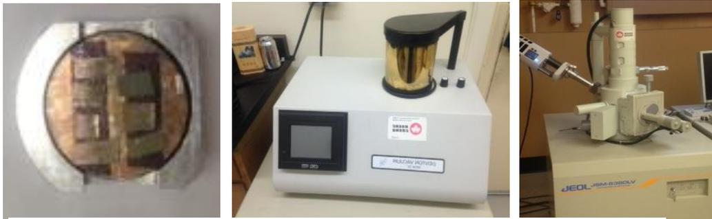
a) Membrana sometida a bombardeo de iones metálicos de oro; b) Denton Vaccum Deskk IV; c) Escáner Microscópico de Electrón JSM-6380LV.
