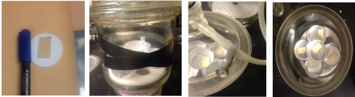
a) Corte de membrana de referencia; b) Cinta se seguridad para evitar implosión; c) Sujetador de control de vacío; d) Platos contenedores de aluminio.
