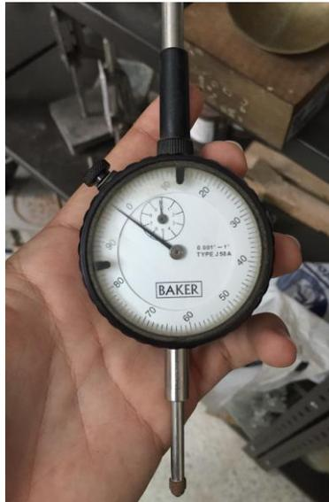
Figura N°22. Deformímetro Baker
