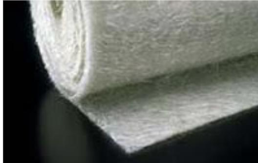
**Figura N°14.** Muestra de Mat de filamento continuo
