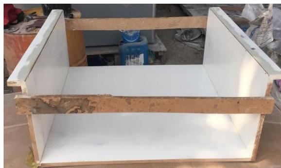
Figura N°32. Molde de Madera, con el Gelcoat seco y pulido.
