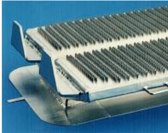
**Figura N°4.** Bushing con doble plato base
