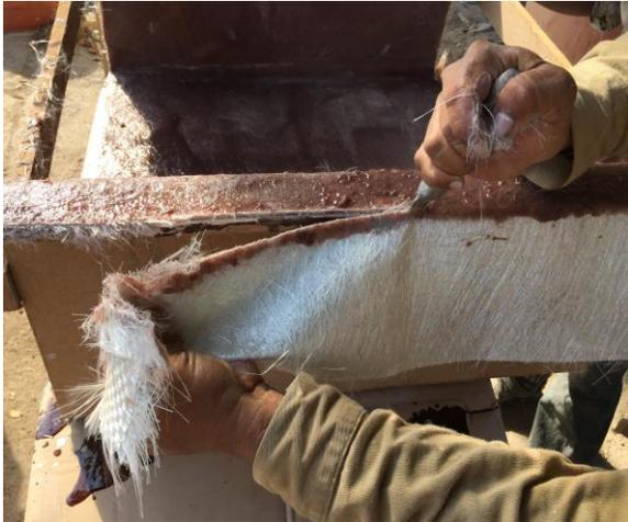
**Figura N°42.** Corte de material sobrante
