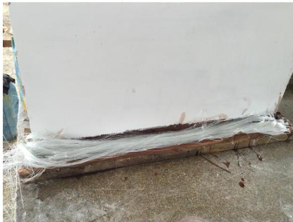
**Figura N°60.** Aplicación hilo en las pestañas laterales laterales.
