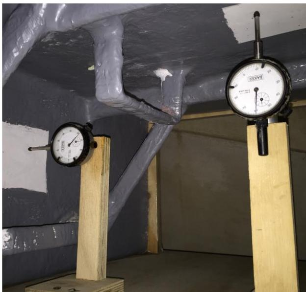
**Figura N°68.** Torres de madera con deformímetros realizando medidas .
