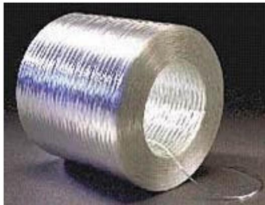
**Figura N°9.** Rollo de Roving
