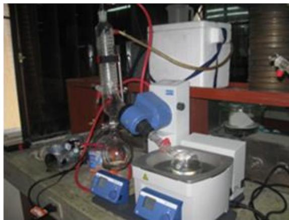
Figura 3.4. Rotaevaporación de muestras.
