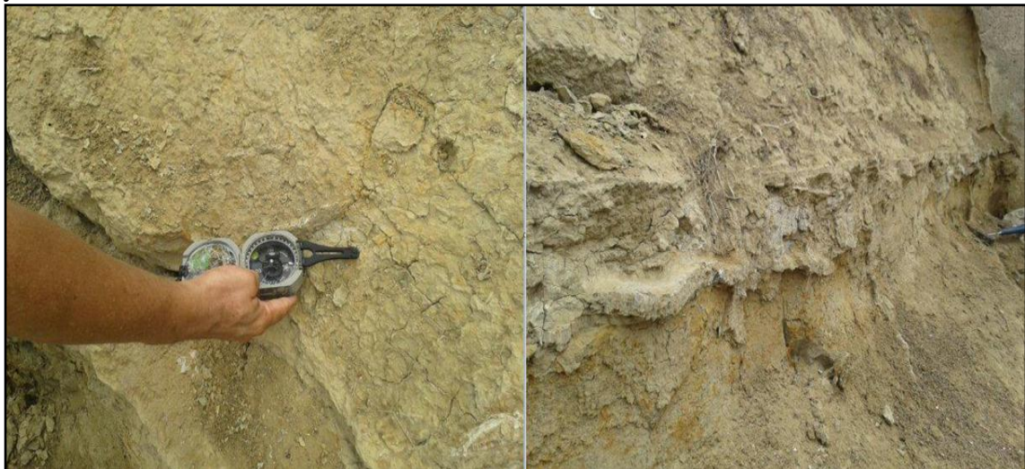
Figura 20. Detalles del afloramiento anterior. Izquierda: fracturas verticales con rellenos de yeso, orientación NS. Derecha: Estratificación horizontal de los estratos.
