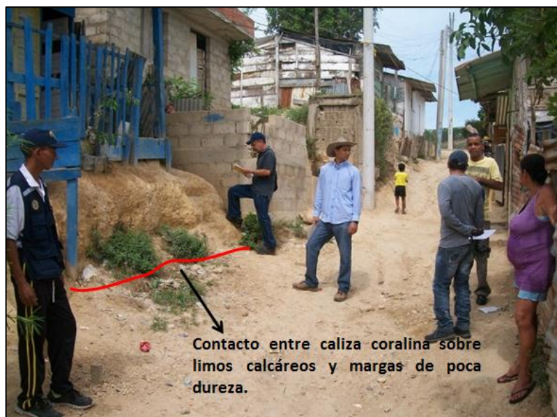
Figura 25. Contacto entre caliza coralina ligeramente cementada de color crema amarillento, sobre limos calcáreos y margas de poca dureza.
