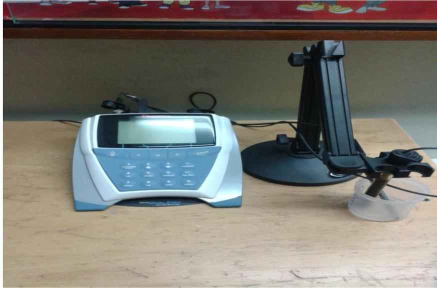
Instrumento de medición (potenciómetro)
