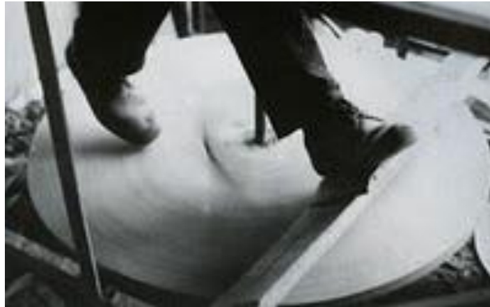
Ilustración 1 Torno impulsado por el pie
