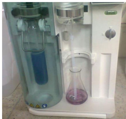
Figura 14. Determinación del contenido de proteínas de la pulpa de Mango de Azúcar ( Mangifera Indica L ).
