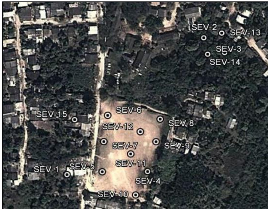
Figura 47. Sondeos geo-eléctricos verticales en Membrillal
