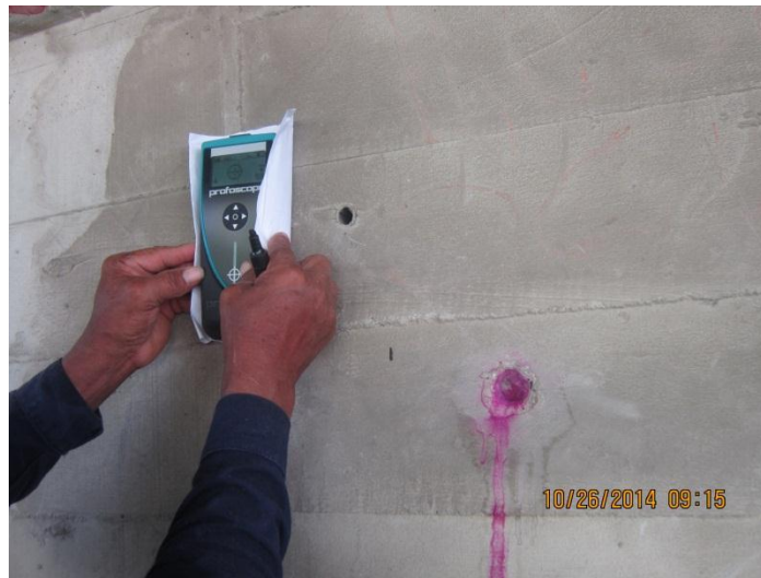
Imagen 22. Prueba del pachómetro.
