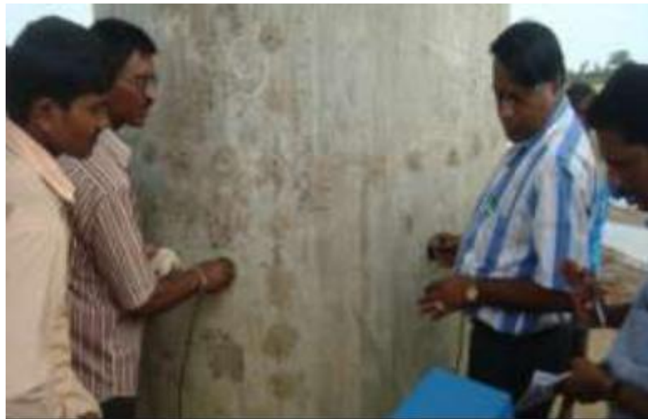
Imagen 6. Prueba de Puente Pier usando Ultrasonic Tester
