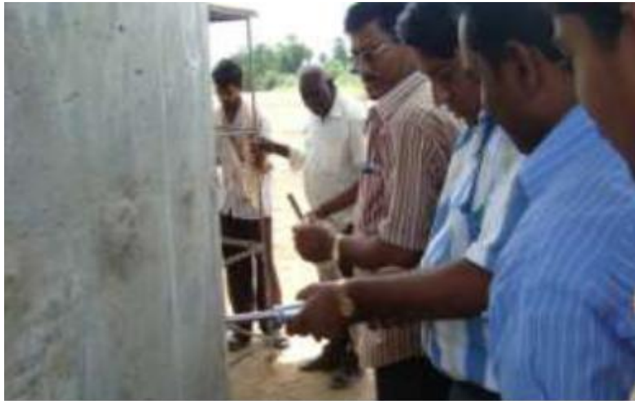
Imagen 5. Pruebas de Puente Pier usando martillo de rebote
