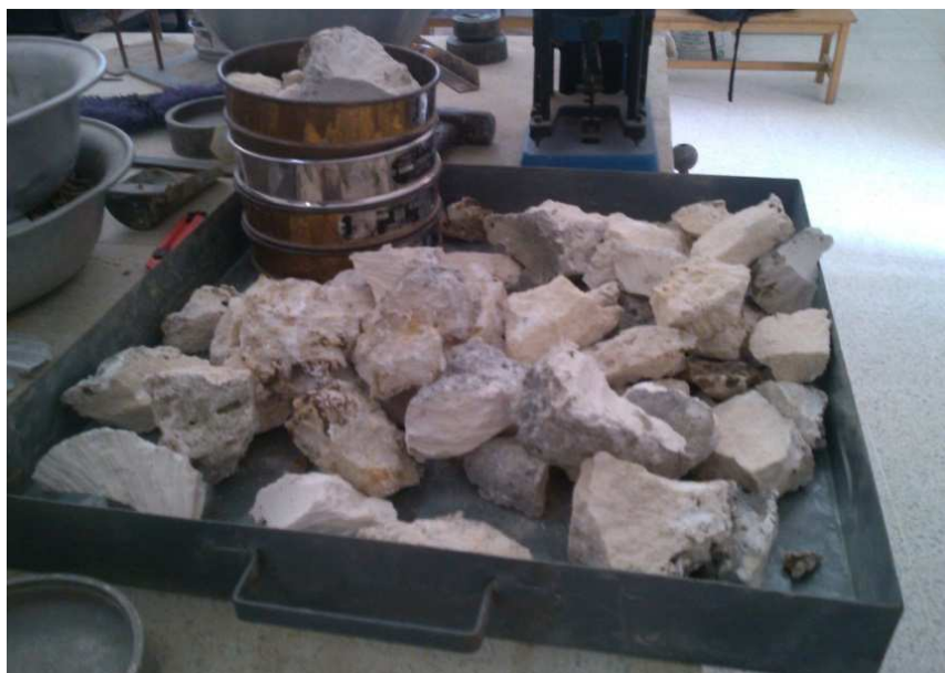
Ilustración 40. Serie de tamices utilizada y muestra a ensayar Fuente: (Autores, 2014).
