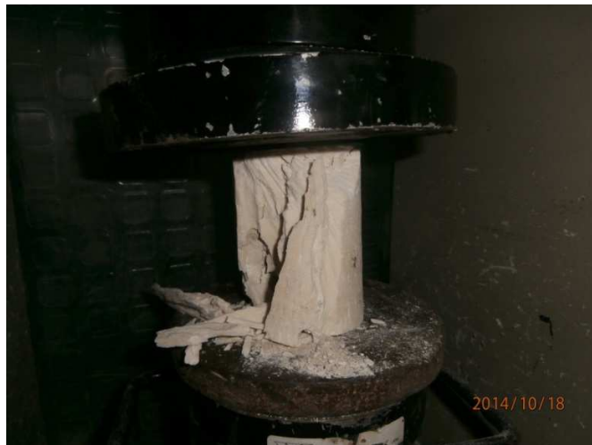
Ilustración 44. Muestra al finalizar la prueba Fuente: (Autores, 2014)
