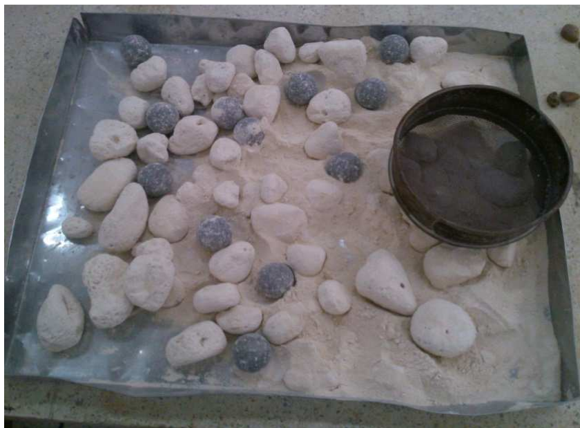
Ilustración 41. Muestra sacada de la Maquina de los Ángeles Fuente: (Autores, 2014)
