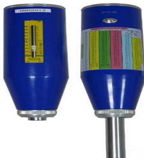
Ilustración 27. Martillo de Schmidt Fuente: (PCE instrument, 2013).
