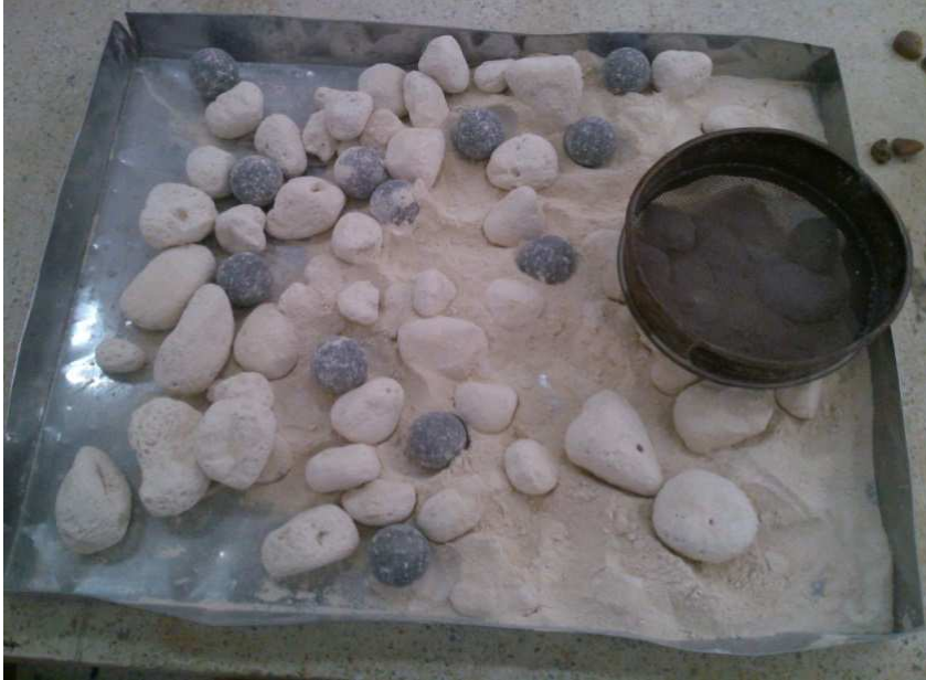
Ilustración 41. Muestra sacada de la Máquina de los Ángeles
