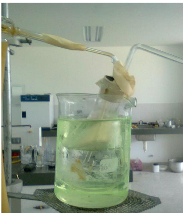
Figura 5.2. Sistema de refrigeración improvisado.
