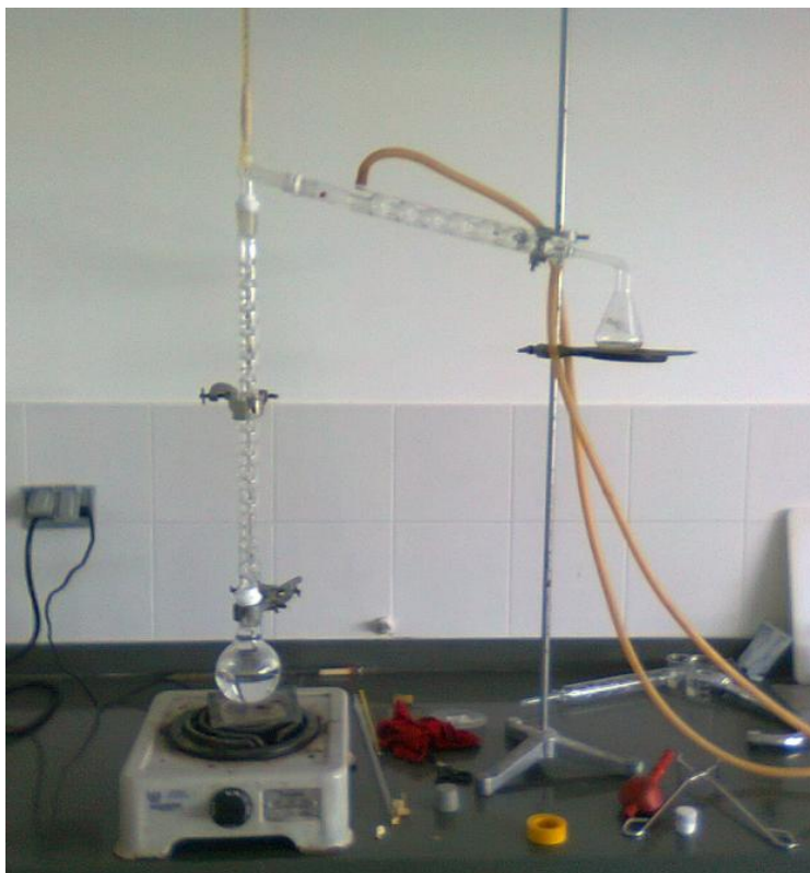
Figura 5.1. Montaje de laboratorio para destilación azeotrópica.
