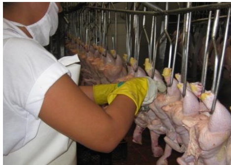
Ilustración 8 Extracción de cloaca
