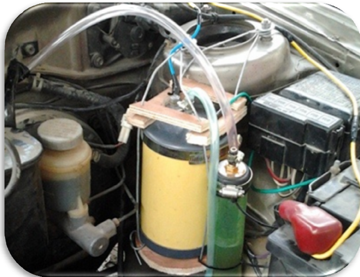
Figura 13. Instalación completa del sistema electrolizador
