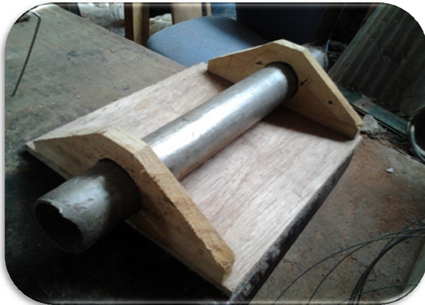
Figura 4. Rodillo utilizado para construir los electrodos en espiral.
