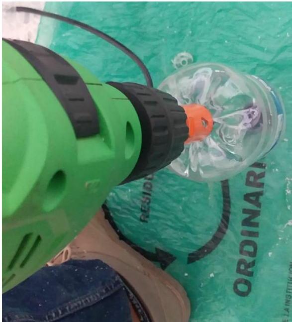
Ilustración 18. Perforación de botellas PET. Fuente: (Barón & Navarro, 2020)
