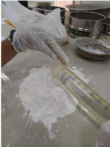
*Ilustración 17. Homogenización de muestra de cal con determinado porcentaje de agua. Fuente: Autores.*
