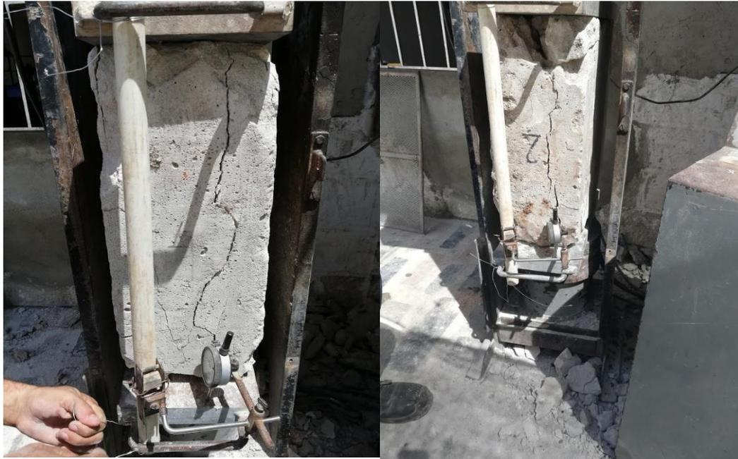
*Ilustración 33. Falla típica de muretes ensayados a la compresión sin reforzar.*
