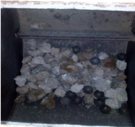
*Ilustración 8. Muestra de roca coralina dispuesta en máquina de los Ángeles. Fuente: Autores.*
