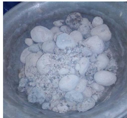
*Ilustración 13. Muestra de roca caliza que paso el tamiz No 12. Fuente: Autores.*
