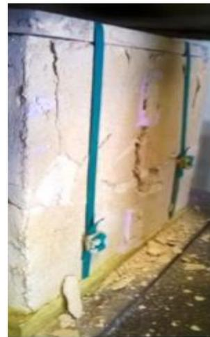
*Ilustración 5. Fisuración del revoque en murete, reforzados con malla electro-soldada.
