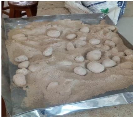
*Ilustración 9. Muestra de roca coralina luego de ensayo de desgaste en máquina de los Ángeles. Fuente: Autores.*
