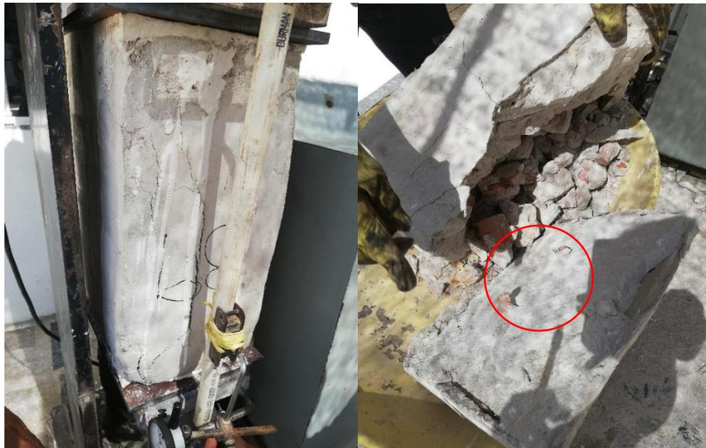
*Ilustración 34. Falla muretes reforzados con anclaje y estado luego de ser bajado de la máquina universal. Fuente: Autores.*
