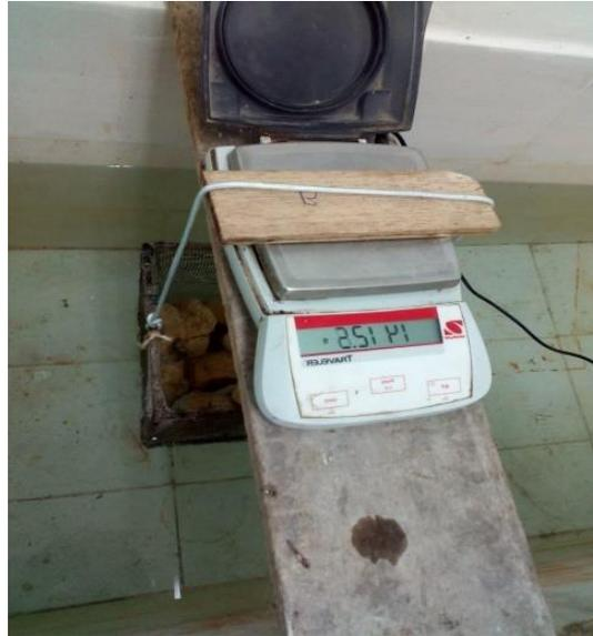
*Ilustración 16. Muestra de roca caliza saturada, sumergida. Fuente: Autores.*
