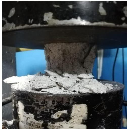
Ilustración 32. Cubo de mortero de cal y arena luego de ser ensayado.
