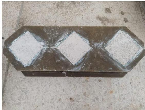
*Ilustración 22. Cubos de mortero en proporciones 1:2 de cal y arena (argamasa). Fuente: Autores.*
