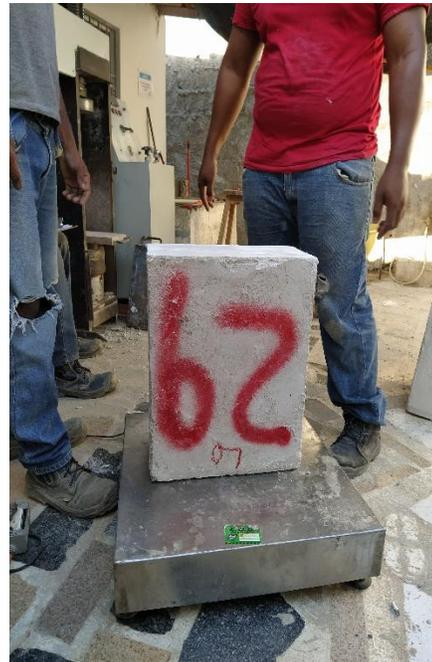
*Ilustración 30. Pesado de murete en laboratorio previo al ensayo.
