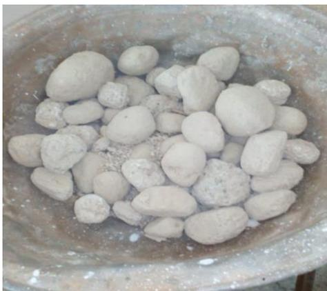
*Ilustración 10. Muestra de roca coralina que paso el tamiz No 12. Fuente: Autores.*
