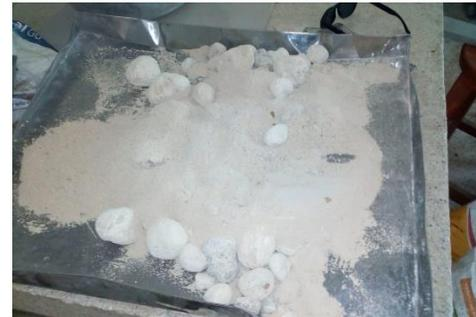
*Ilustración 12. Muestra de roca caliza luego de ensayo de desgaste en máquina de los Ángeles. Fuente: Autores.*
