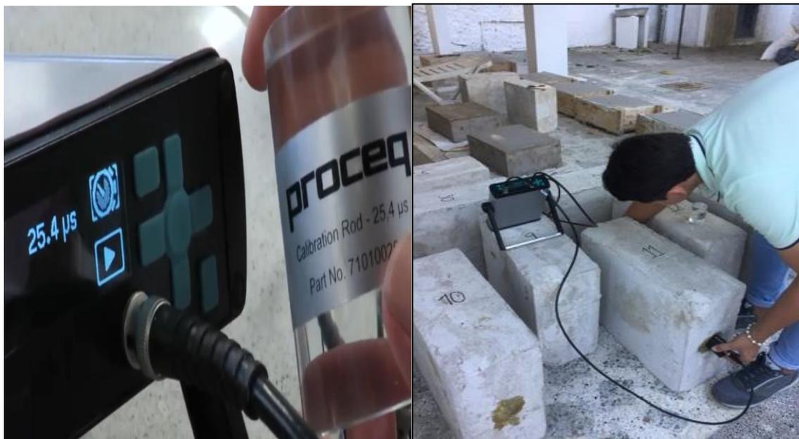
*Ilustración 24. Esayo de ultrasonido sobre muretes de concreto colonial.
