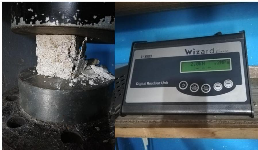
*Ilustración 31. Ensayo de compresión a cubo de mortero de cal y arena.
