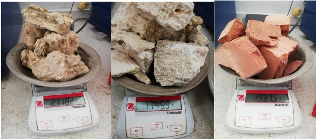
*Ilustración 14. Muestra de roca caliza, coralina y ladrillo militar sometido a ensayo de humedad.*
