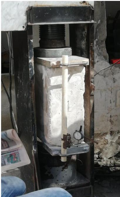
*Ilustración 29. Ensayo de compresión en murete.
