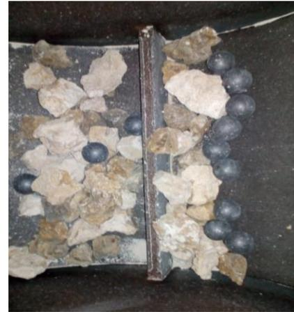
*Ilustración 11. Muestra de roca caliza dispuesta en máquina de los Ángeles. Fuente: Autores.*
