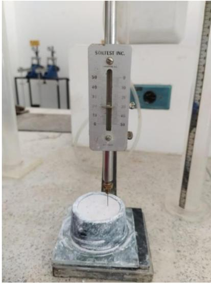
*Ilustración 19. Ensayo de tiempo de fraguado a muestra de cal. Fuente: Autores.*
