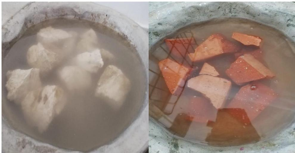
*Ilustración 15. Muestras de roca coral y ladrillo militar saturadas. Fuente: Autores.*
