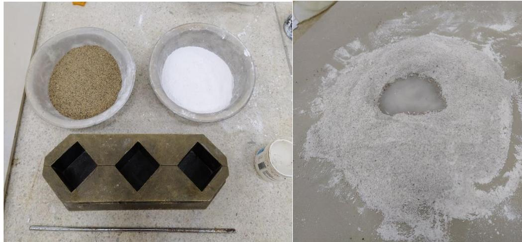
*Ilustración 21. Elaboración de cubos para ensayo de resistencia al mortero. Fuente: Autores.*
