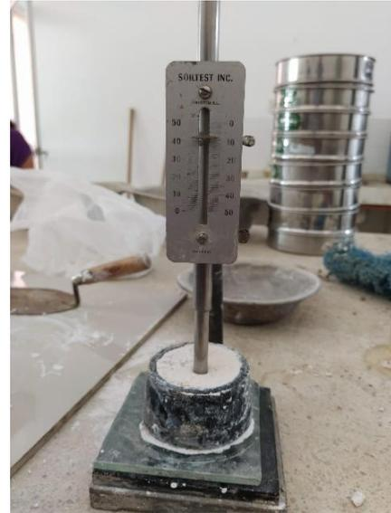
*Ilustración 18. Disposición de la pasta sobre molde en aparato de Vicat. Fuente: Autores.*
