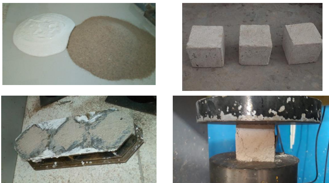
Figura 46. Ensayo de resistencia a la compresión del mortero a base de cal apagada sin reforzar
