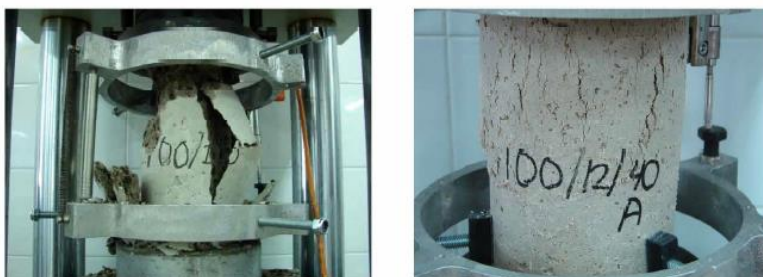
Figura 1. Imagen de dos probetas rotas a compresión en prensa. Aligerado con métodos convencionales (izquierda) y reforzado con fibras de polipropileno más granulado de corcho (Derecha).
