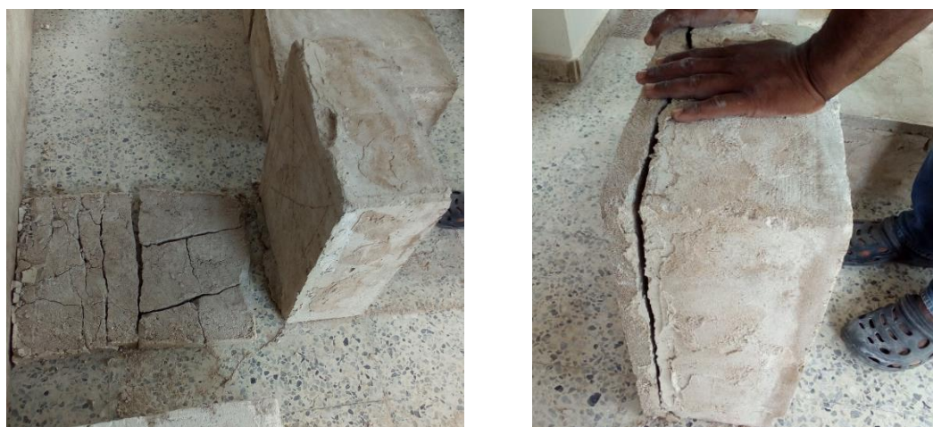
Figura 51. Desprendimiento del mortero de revestimiento de los muretes
