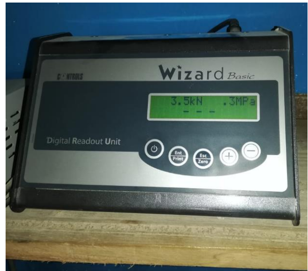
Figura 41. Resistencia a la compresión del cubo de mortero
