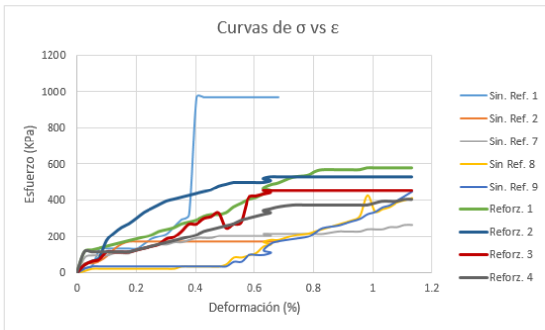
Gráfica 11. Curvas de esfuerzo Vs. Deformación para los muretes con y sin revestimiento.
