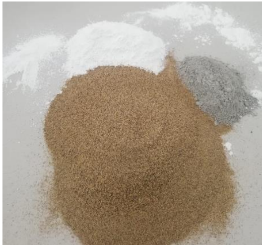
Figura 34. Materiales usados para fabricar cubos de mortero (cal, cemento, arena)
