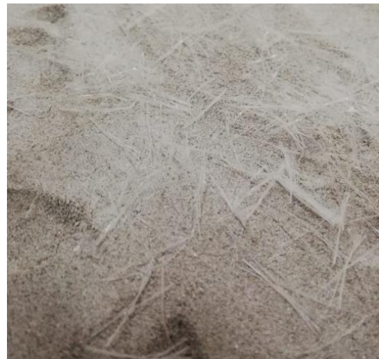
Figura 37. Adición de fibra a la muestra de mortero
