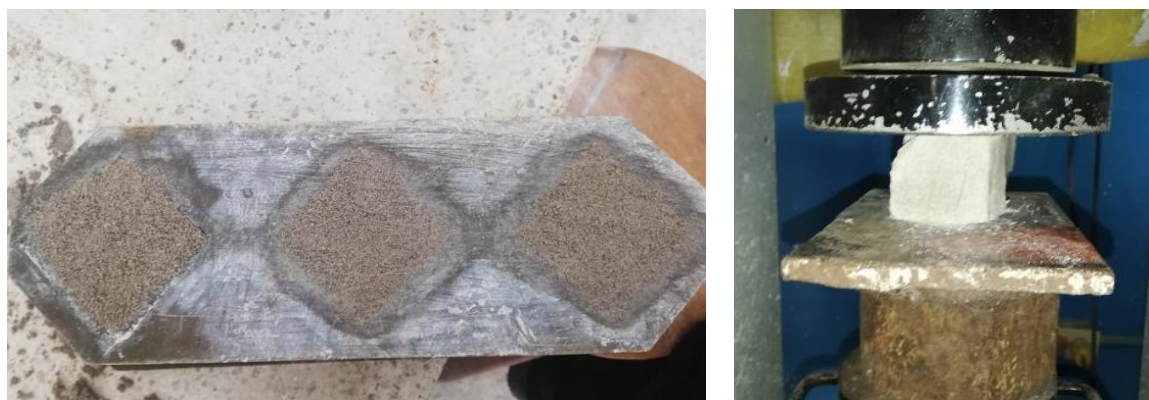
Figura 33. Ensayo de resistencia a la compresión del mortero a base de cal (cal:arena)
