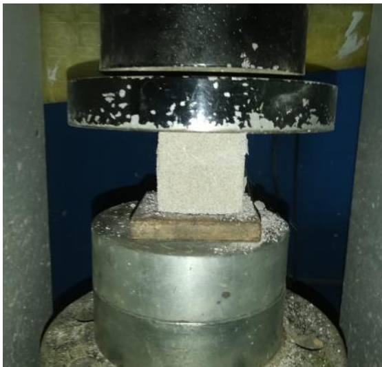
Figura 40. Cubo de mortero durante ensayo de compresión simple, adición de 0.13% de fibra.
