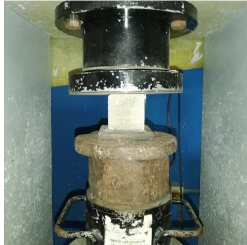
Figura 39. Ensayo de compresión simple sobre cubos de mortero
