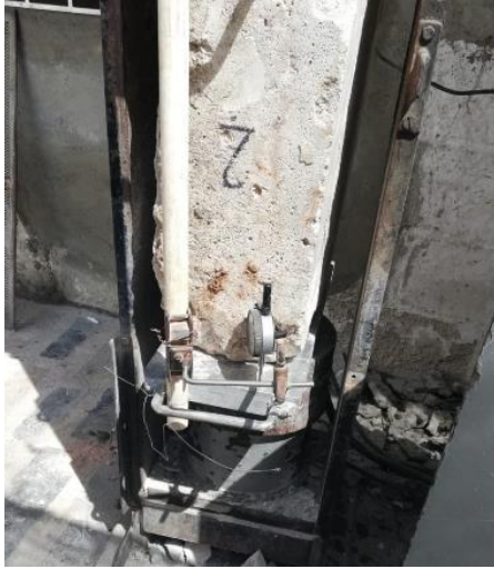
Figura 58. Ensayos de compresión simple sobre muretes sin reforzar
