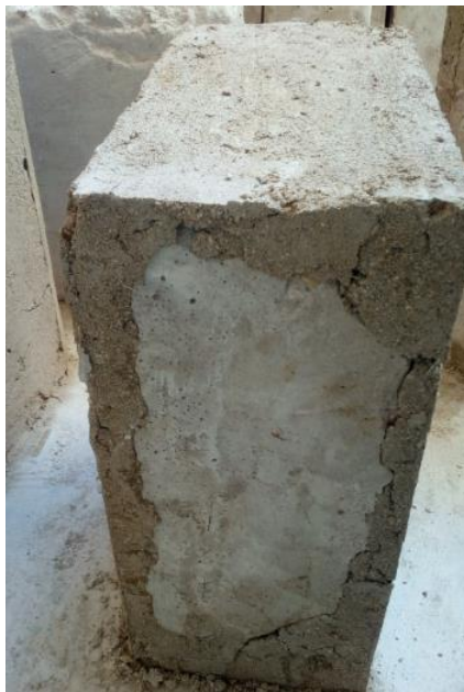
Figura 54. Revestimiento de muretes con mortero a base de Cal apagada reforzado con fibras al 0.06%
