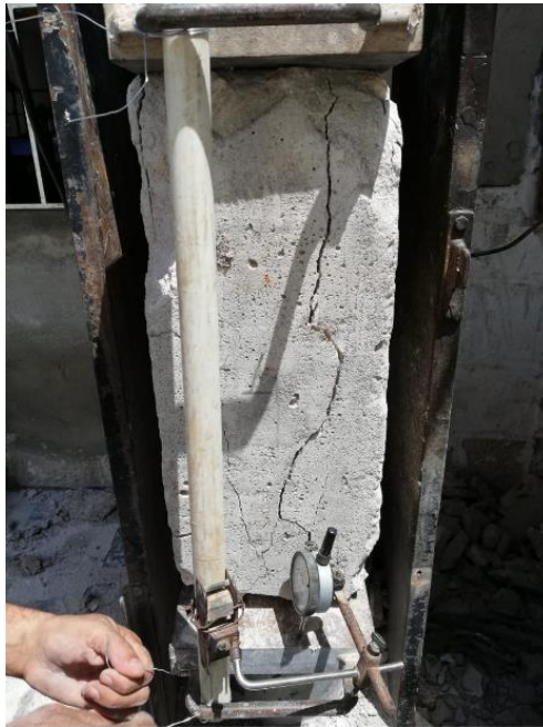
Figura 59. Ensayos destructivos de compresión simple sobre muretes sin refuerzo
