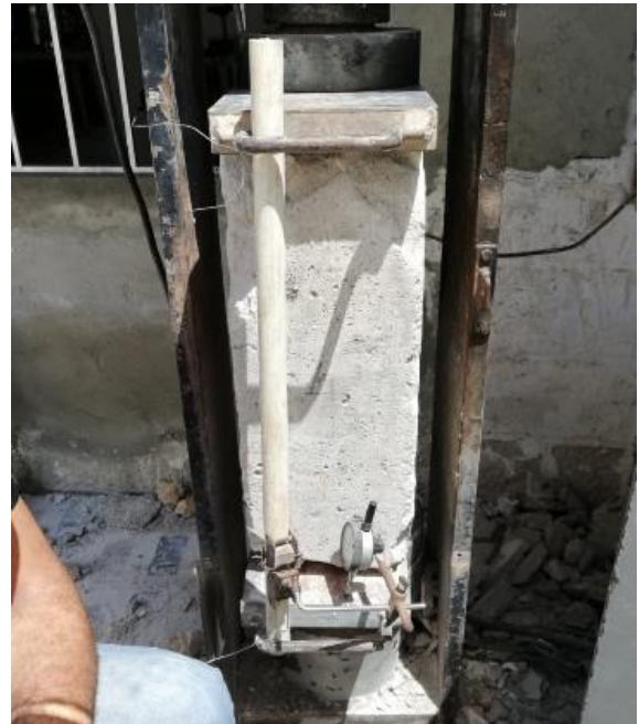
Figura 59. Ensayos destructivos de compresión simple sobre muretes sin refuerzo
