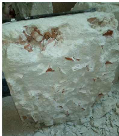
Figura 53. Proceso de remoción del pañete exterior de los muretes
