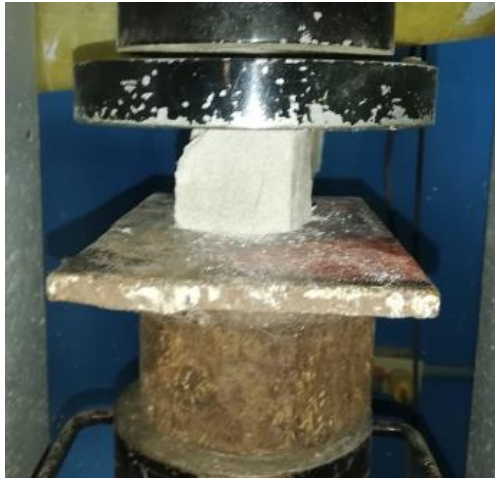
Figura 42. Cubo de mortero con adición de 0.24% de fibra durante prueba de compresión simple
