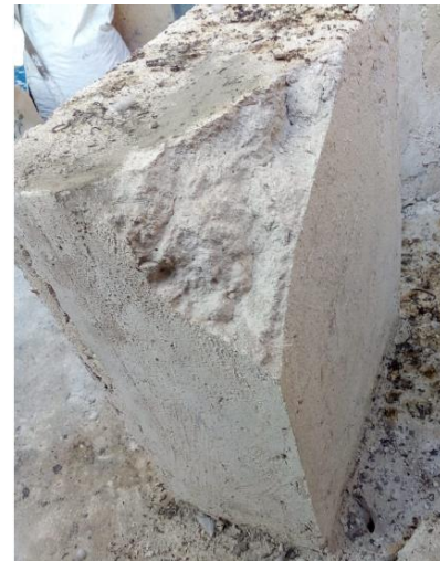
Figura 55. Agrietamiento y desprendimiento del mortero de revestimiento a base de cal apagada
