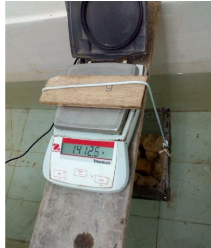
Figura 30. Peso sumergido piedra caliza
