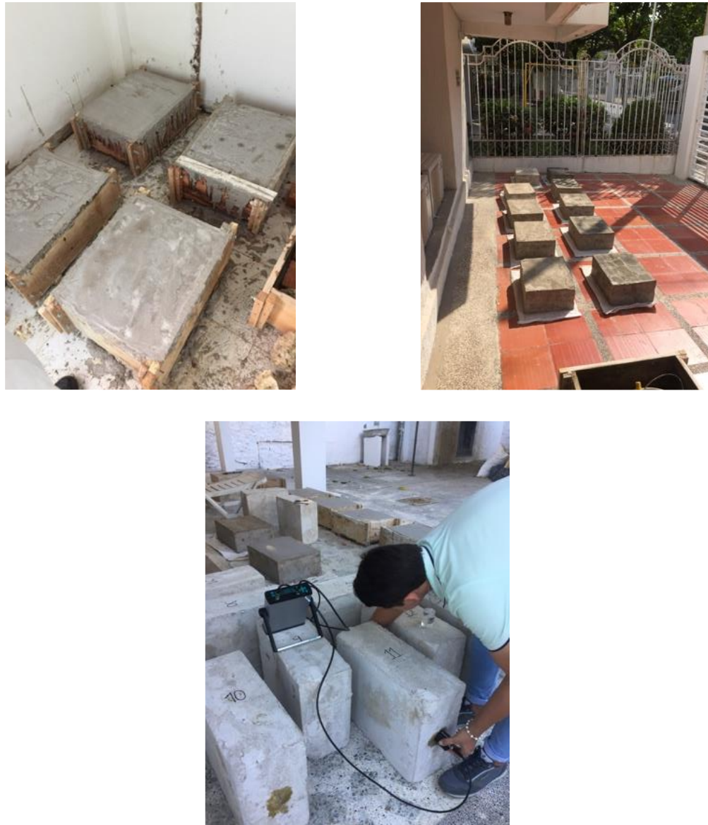
Figura 48. Realización de ensayos de ultrasonido sobre los muretes
