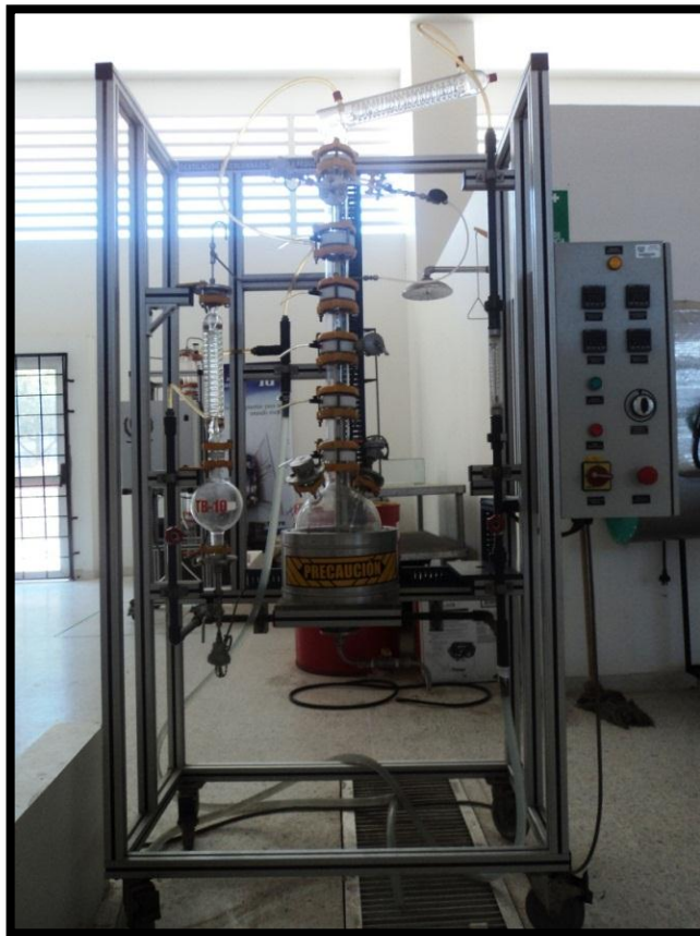
Figura 4. Torre de destilación a escala piloto
